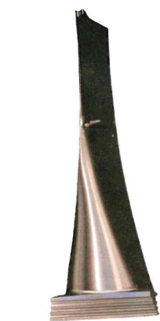
Titanová oběžná lopatka s délkou pracovního listu 1375 mm. Závěs je tvořen přímou stromečkovou nožkou, nad středem listu vazební člen, bandáž na špičce lopatky s těsnicím břitem radiální vůle
