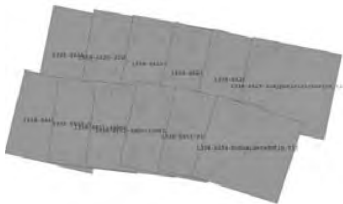
2.3. Schéma bloku kolmých leteckých snímků s laterálními a příčnými překryty (zpracoval autor).
