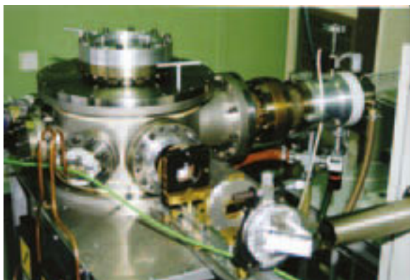
5/ Fotografie PLD komory s přidavným vysokofrekvenčním výbojem a výbojem v duté katodě. Komora umožňuje rovněž kombinovat PLD s magnetronovým naprašováním. Pohled ze strany vstupu laserového paprsku.
