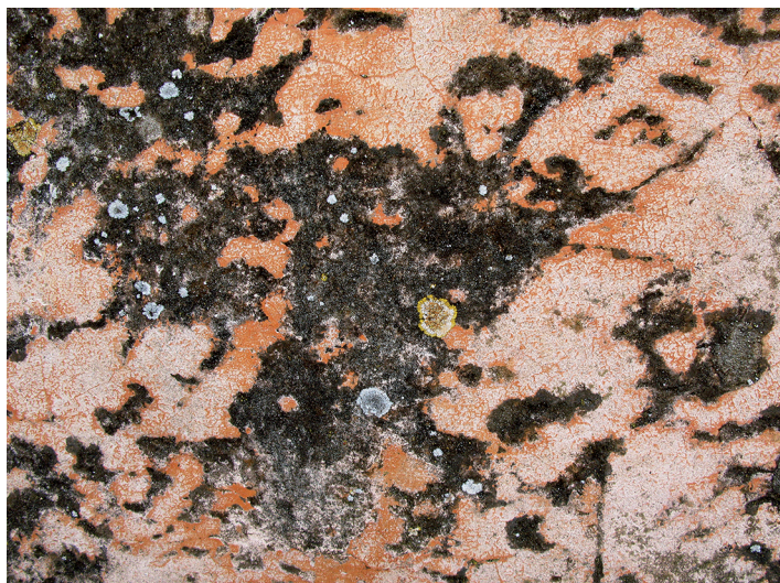
OBRÁZEK 59: Příklad kráterů v povrchové vrstvě (Foto M. Drdácý)
