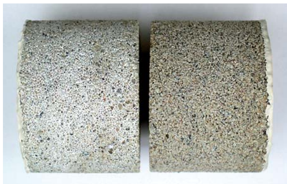
OBRAZEK 159: Změna barvy povrchu maltového tělíska po mnohonásobné aplikaci CaLoSiLu IP 25 (vlevo) ve srovnání s původním vzhledem malty (vpravo)
