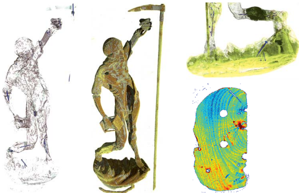
OBRÁZEK 255: Vlevo je vizualizace kovových spojovacích prvků a fragmentů povrchových vrstev; uprostřed je dřevorezba obarvená dle hustoty materiálu se zvýrazněnými fragmenty polychromie; vpravo nahoře je detail spodní části, dobře viditelný hřebíček a výrazně jiná struktura pravého lýtká – zřejmě doplňování materiálu během pozdějších zásahů; vpravo dole je vodorovný řez podstavy, s patrnými chodbičkami červotoče, uprostřed v levé části „vodorovná“ prasklina, v horní části je další prasklina zasahující ke kraji, červená skvrna vpravo nad středem odpovídá přítomnosti kovových prvků.
