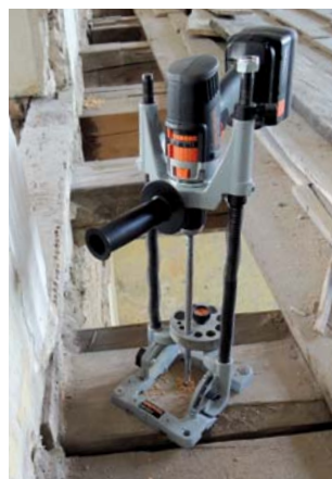
OBRAZEK 12: Speciální stojánek pro upevnění vrtáčky s vrtákem a ukotvení k prvku
