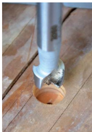
OBRAZEK 11: Detail frézovacího vrtáku pro přípravu vrtu průměru 12 mm
