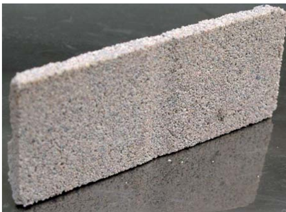
OBRÁZEK 151: Tenká deska pro tahovou zkoušku
