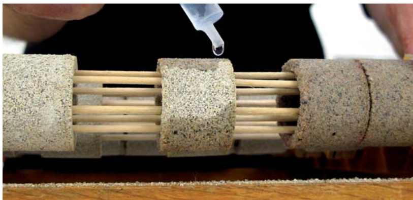
OBRÁZEK 154: Penetrování tenkostěnných rour pro tlakové zkoušky
