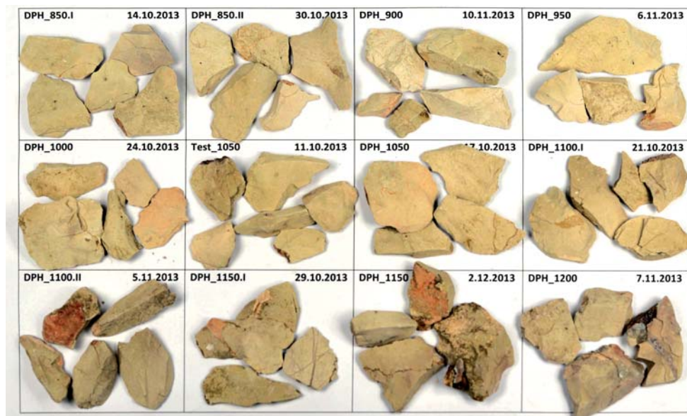
OBRAZEK 135: Srovnání barvy přirozeně hydraulického vápna po výpalu od 850 do 1200 °C. Velikostní frakce 10–15 mm
