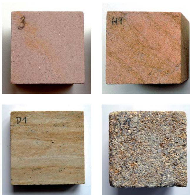
OBRAZEK 47: Pískovce ze Mšena (nahore vlevo) a z Hořic (nahore vpravo), opuka (dole vlevo) a arkóza (dole vpravo)
