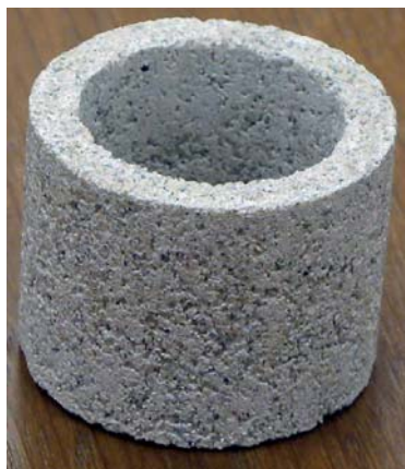
OBRÁZEK 150: Těleso pro tlakové zkoušky
