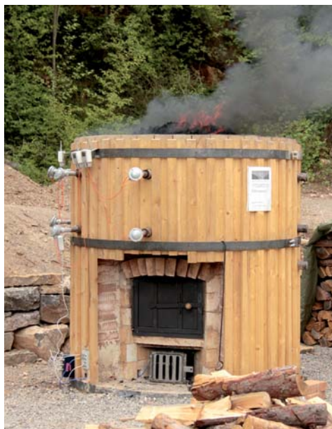
OBRAZEK 131: První výpal vápna v experimentální vápenné peci
