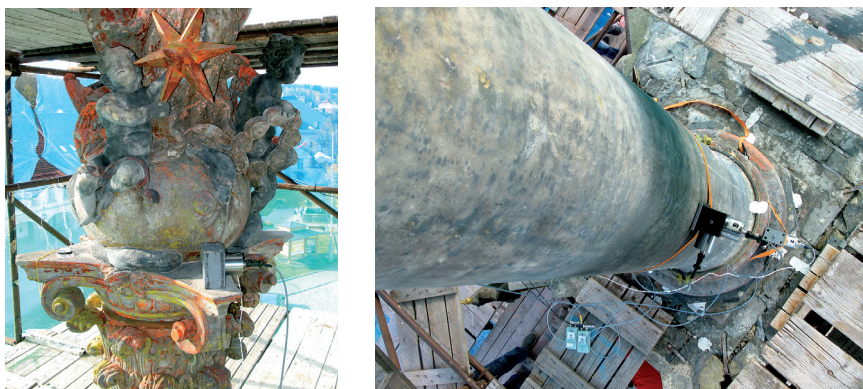
OBRAZEK 261: Umístění snímačů kmitání v úrovni hlavice sloupu (vlevo) a na dřívku (vpravo)
