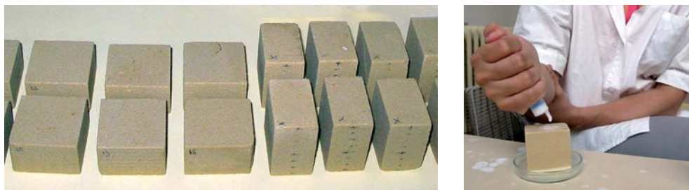
OBRAZEK 160: Sada zkušebních těles maastrichtského vápence (vlevo) a postup zpevňování jednoho vzorku smáčením povrchu kamene vápennou nanodisperzí pomocí injekční stříkačky (vpravo)
