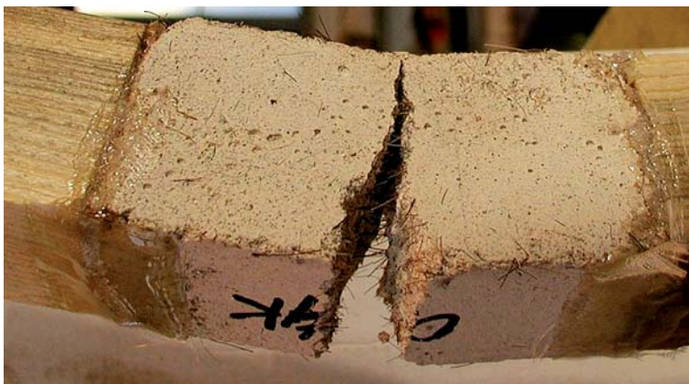
OBRÁZEK 3: Ukázka způsobu zesílení lepeného spoje podkladní bandáží
