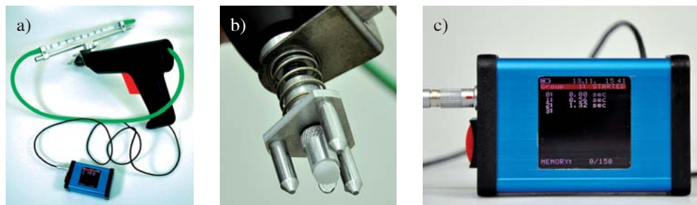
OBRAZEK 44: a) plastová pistole s mikrotrubicí a připojené záznamové zařízení; b) hlaveň s třemi opěrnými hroty naplněná cigaretovým filtrem; c) kovová krabička chránící paměť s uloženými daty
