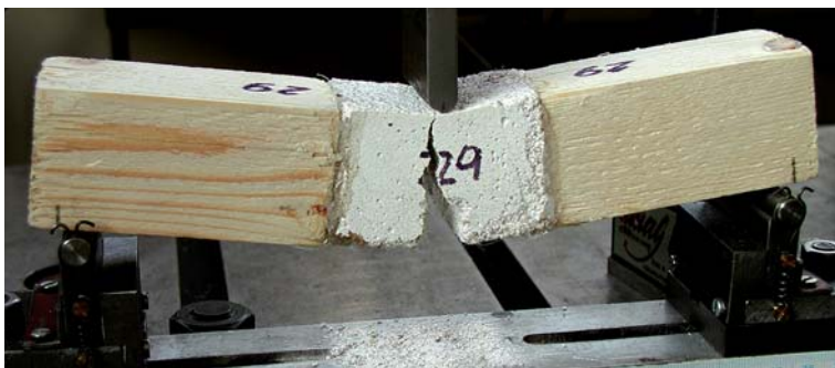
OBRÁZEK 4: Příklad zkoušky protézované malty vyztužené vlákniny
