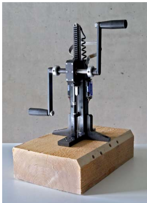
OBRÁZEK 16: Přístroj pro měření mechanického odporu dřeva při zatlačování trnu
