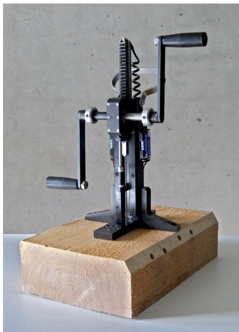
OBRÁZEK 16: Přístroj pro měření mechanického odporu dřeva při zatlačování trnu
