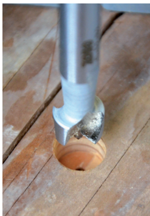
OBRÁZEK 11: Detail frézovacího vrtáku pro přípravu vrtu průměru 12 mm
