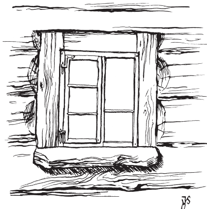
Okénko jizby s nepohyblivým pravým okenním křídlem. Staré Hamry-Klepačka (Moravskoslezské Beskydy)
