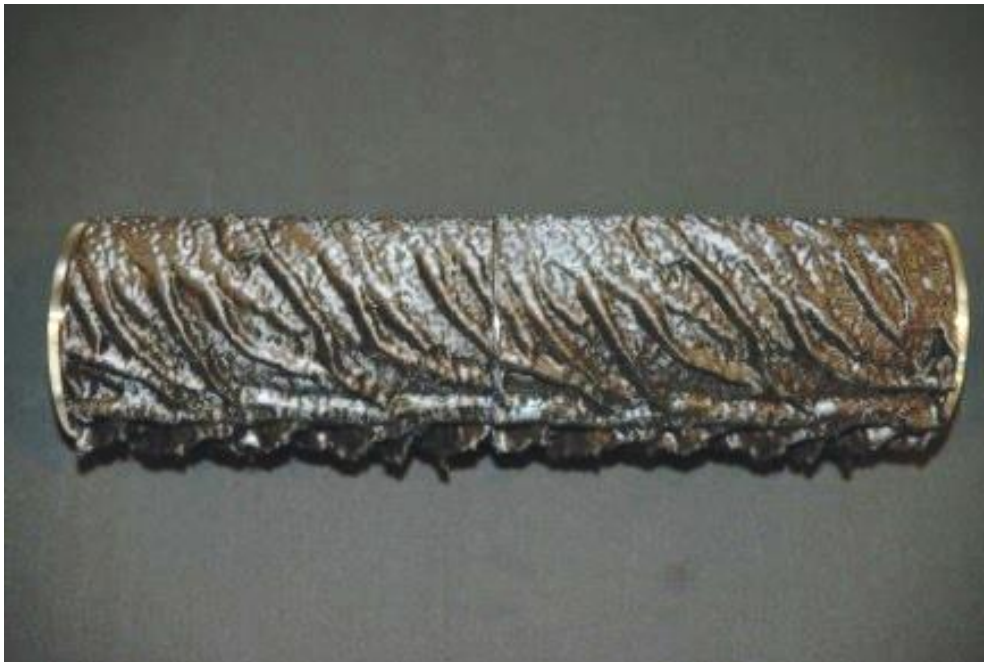
3D model táhla s reprodukovanou námrazou
