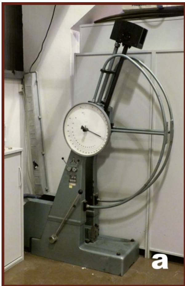
Zkušební zařízení - kyvadlové (Sharpyho) kladivo (WPM – VEB Werkstoffprüfmaschinen, Leipzig) a schéma uložení zkušebního tělesa
