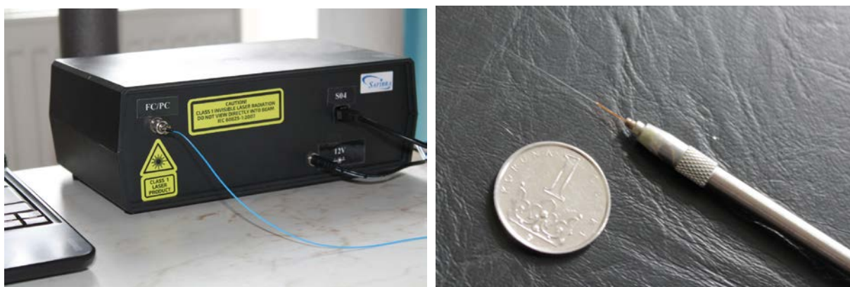
Obr. 4 Fotografie optoelektronické jednotky vlákno-optického pH-metru a optické sondy.
