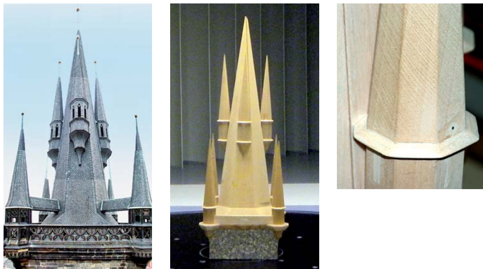
OBRÁZEK 220: Gotická věž s ostrými hranami slouží jako vzor věže pro numerický výpočet i pro experimentální model. Uprostřed - balsový model umístěný v aerodynamickém tunelu. Vpravo - detail věžičky s drobným otvorem ke snímání tlaku. Tlaky na povrchu modelu jsou přenášeny hadičkami až ke snímačům, umístěným obvykle uvnitř modelu či pod měřicím prostorem.
