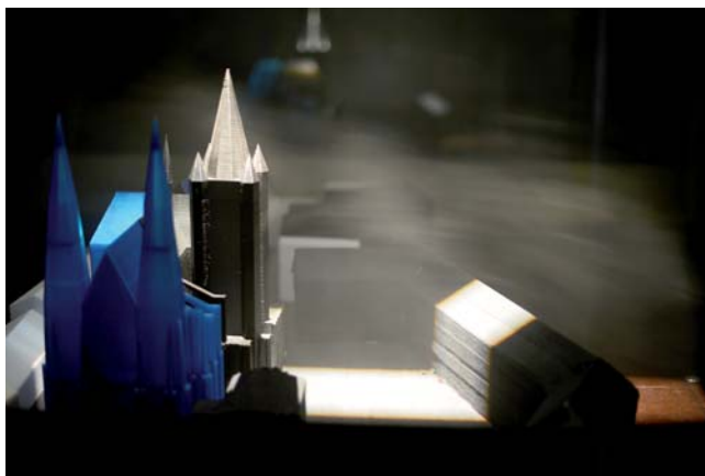
OBRÁZEK 227: Vizualizace proudění v blízkém okolí vzácné mozaiky Posledního soudu na katedrále sv. Víta na Pražském hradě. Otočný stůl umožňuje měření tlaků na modelu ze všech možných směrů větru a tudíž jeho komplexní analýzu.
