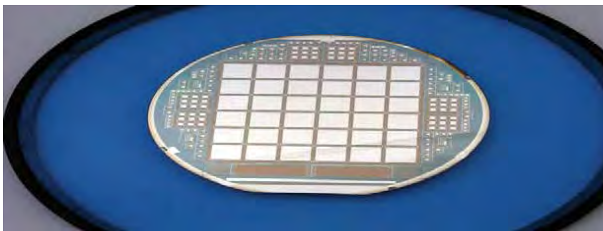
■ Obr. 5 Křemíková deska s maticí 6x6 padových senzorů vyrobená v ON Semiconductor (dříve TESLA, Rožnov pod Radhoštěm) pro elektromagnetický kalorimetr projektu CALICE.
