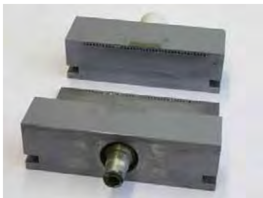
■ Obr. 13 Řez monochromátorem, na kterém jsou vidět chladicí kanálky
