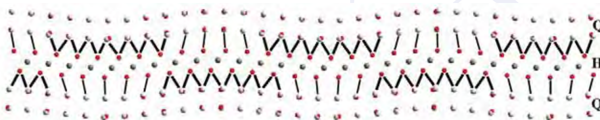
■ Obr. 6 Podsystemy H a Q a jejich vzájemná interakce ve struktuře cylindritu. Smíšené polohy cínu a železa jsou označeny šedě, selen je značen červeně a smíšené polohy cínu a olova bíle.
