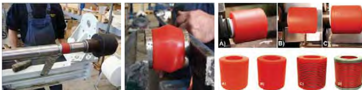
■ Obr. 9 Kompozitní těsnící prvek „Air splitting collar“ ze specialních plastů a pružiny NiTi pro moderní neexplozivní stroj k lámání kamene
