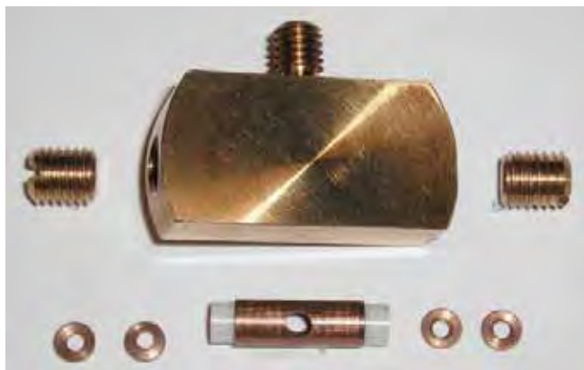
/// Obr. 9 Unikátní jednoosá tlaková cela pro studium magnetických struktur pomocí neutronové difrakce vyvinutá pracovníky oddělení magnetik a supravodičů
