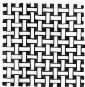
Obr. 12. Schéma plátnové vazby. Kresby na obr. 12–14 K. Poppová Urbanová. Fig. 12. Schema of woven cloth.
