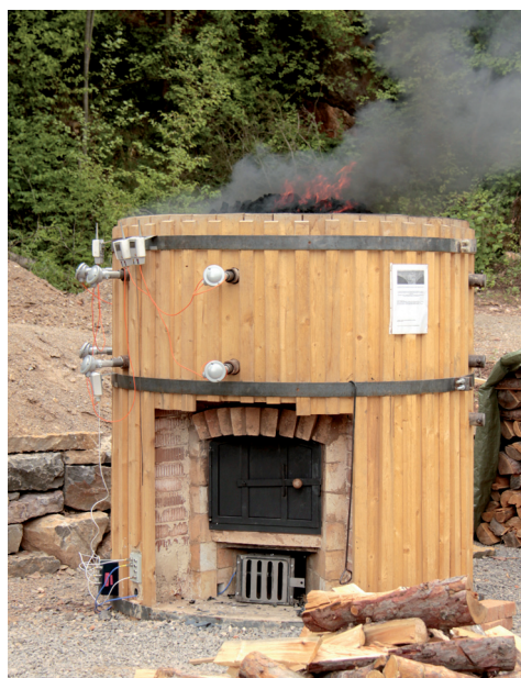
OBRÁZEK 131: První výpal vápna v experimentální vápenné pece
