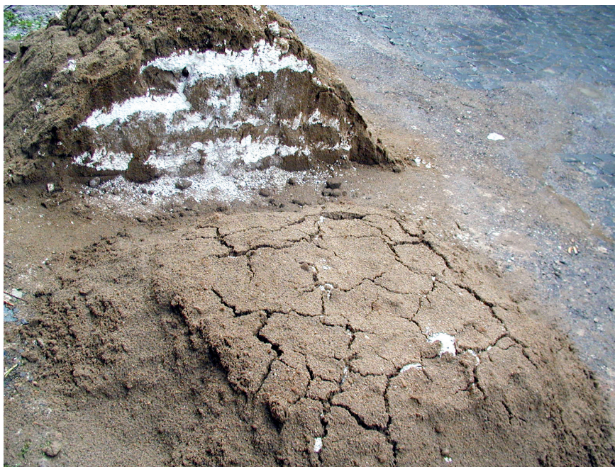
OBRÁZEK 136: Příprava horké malty, kdy vrstvy vápna s pískem jsou ponechány několik desítek dní ve venkovním prostředí. Vápno se postupně vyhasí (Foto M. Hřeka)
