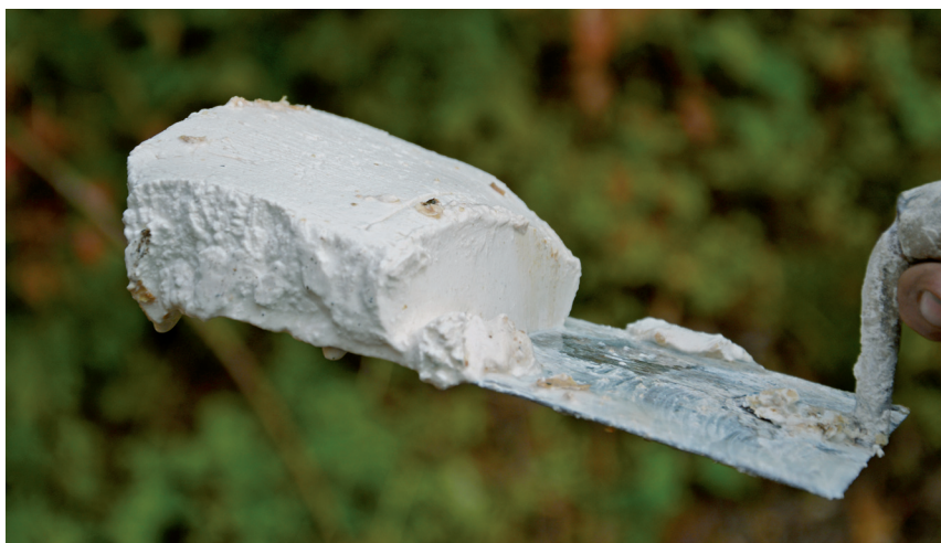
OBRAZEK 134: Dva roky odležená vápenná kaše má pevnou konzistenci a drží tvar po vyjmutí z jámy
