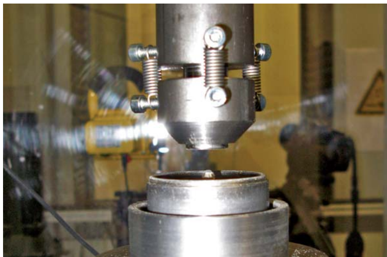
OBRÁZEK 195: Příklad úpravy zatěžovacího zařízení pro zkoušení kruhových desek
