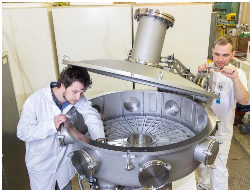
Nová vakuová komora pro studium reakcí (n,xng) na neutronových generátorech CANAM.
