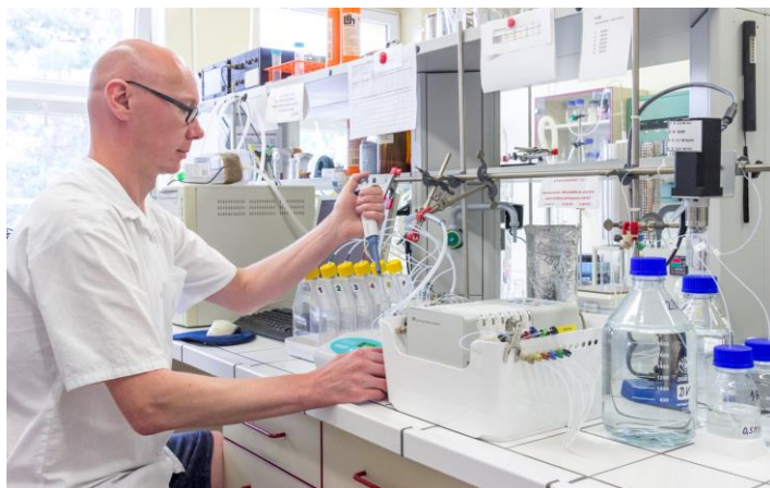
Aparatura pro počítačem řízenou předúpravu vzorků (vlevo), běžně používané kolonky (pravý střed), námi používané kolonky ze zkumavek (vpravo).
