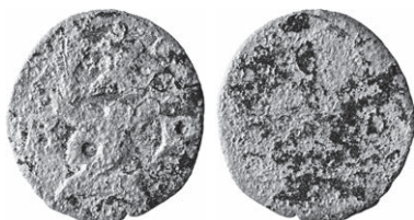
Obr. 2. Makrofotografie falza č. 3 – detail části koruny a litery W s patrnou vrstvou intermetalické fáze obsahující cín v místech nevystavených otěru, s obnaženým měděným jádrem v oblastech s vyvýšeným reliéfem a s typickou podpovrchovou korozí.
