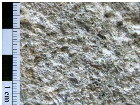
↑ Makrofotografie, detail povrchu v místě erodovaného, otevřeného povrchu horniny po konsolidaci
