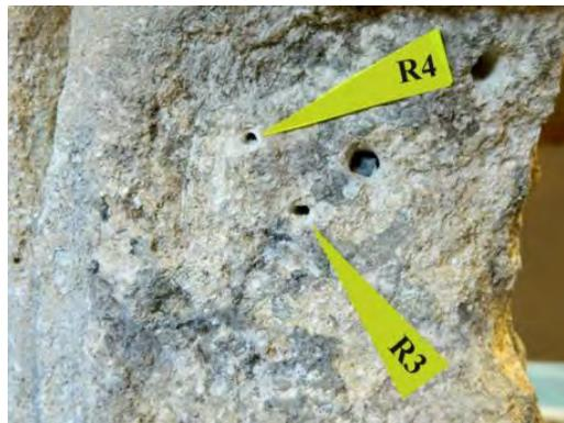
↑ Detail míst měření odporového vrtání – R3, R4
