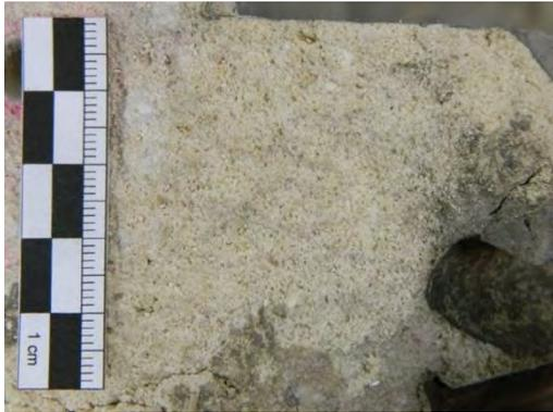
↑ Selektivně erodovaný povrch kamene - zdrsnění, tvorba reliéfu, ztráta části hmoty (makrofoto). Tento typ poškození se vyskytuje zejména v místech, která byla v minulosti pravděpodobně zatížena srážkovou vodou. V důsledku eroze povrchu dochází v těchto místech ke ztrátě původní modelace..
