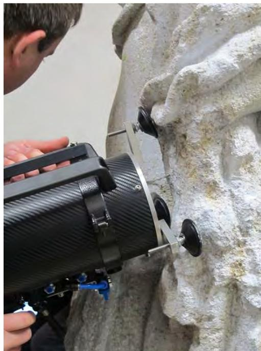
↑ Zjišťování pevnostního profilu odporovým vrtáním (přístroj měřící posuv vrtáku při konstantním přítlaku, Geotron Elektronik, Německo)
