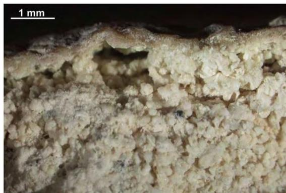
↑ Lomová plocha (mikrofoto) vzorku vápence s tenkou krustou vzniklou jako důsledek sulfatizace povrchu vápence. Krusta se odděluje od horniny pod ní. .
