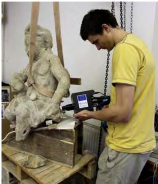
↑ Zjišťování pevnostního profilu odporovým vrtáním (přístroj měřící přítlak při konstantním posuvu, SINT Technology, Itálie)
