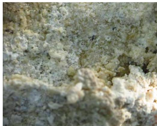
↑ Mikrofotografie, detail struktury povrchu v místě odloučení vrstev
