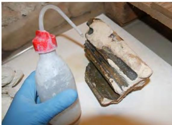
↑ Nanášení konsolidačního prostředku CaLoSil® pomocí laboratorní stříčky v průběhu strukturální konsolidace fragmentu E25BV1
