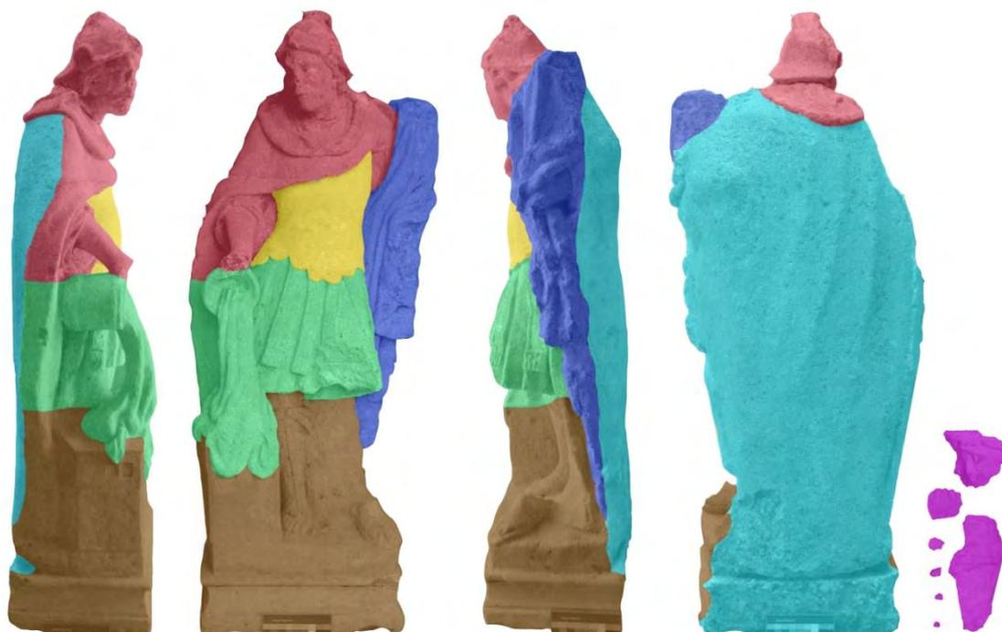
↓ Lokalisierung der einzelnen Tränkungsflächen und farbliche Darstellung des Verbrauchs der Kalk-Nanosuspension CaLoSiL®E25, berechnet in Litern pro m<sup>2</sup>
