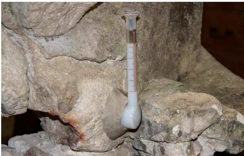
← Měření rychlosti penetrace konsolidačního prostředku pomocí Karstenovy trubice
