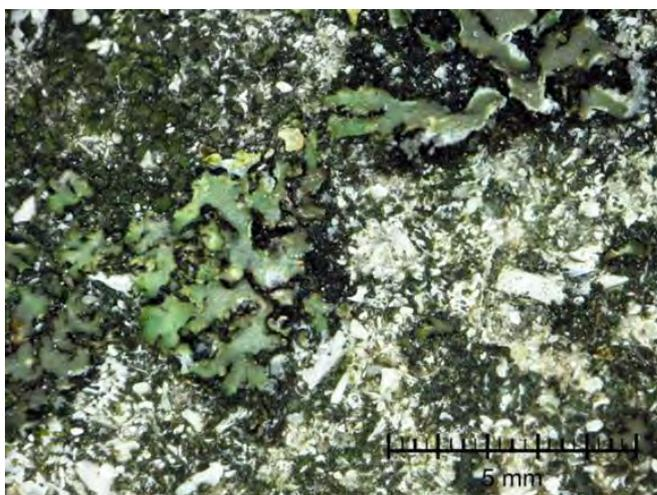
← Mikrofotografie, detail struktury povrchu horniny s biologickou kolonizací (řasy a lišejníky)
