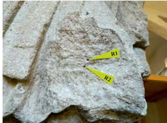
↑ Detail míst měření odporového vrtání – R1, R2
