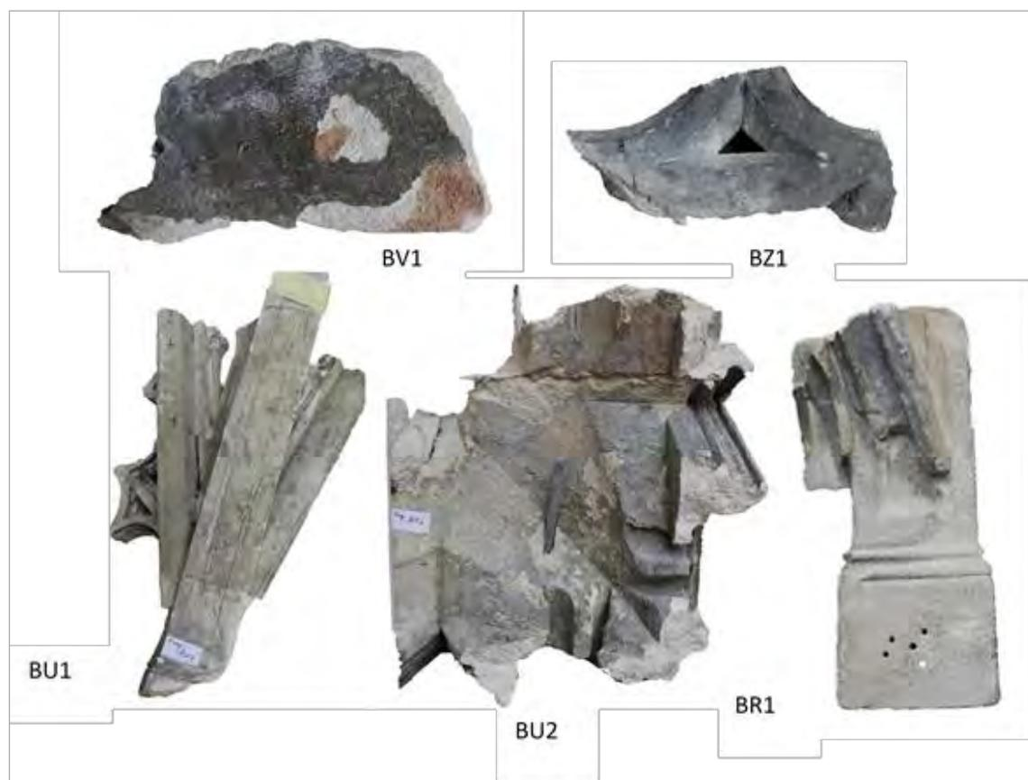
↑ Jednotlivé fragmenty baldachýnu, které byly použité pro zkoušky strukturální konsolidace
