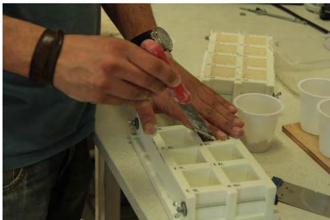
← Příprava zkušebních tělísek dusáním do formy – závěrečné zhutnění písku speciálně připraveným nástrojem
