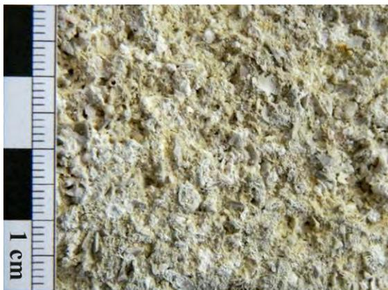
↑ Makrofotografie, detail povrchu v místě erodovaného, otevřeného povrchu horniny před konsolidací
