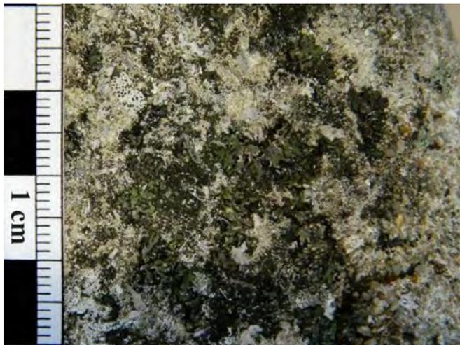
← Makrofotografie, detail struktury povrchu horniny s biologickou kolonizací (řasy a lišejníky)
