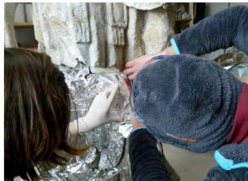
↑ Zjišťování plochy jednotlivých částí napouštěné plochy pomocí vážení. Povrch dané části sochy byl obalen hliníkovou fólií (alobal), ta byla následně zvážena. Plocha byla vypočítána ze zjištěné hmotnosti a z plošné hmotnosti fólie.
