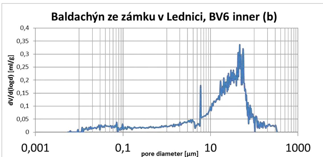
↑ Výsledek měření pomocí rtuťové porozimetrie - objemová distribuce velikosti otevřených pórů vápence použitého na zhotovení baldachýnu z kostela Sv. Jakuba v areálu státního zámku v Lednici.
