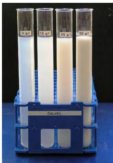
↑ Vápenné nanosuspense s různým obsahem hydroxidu vápenatého
