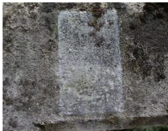
↑ Zkouška zaměřená na redukcí bílého zákalu (spodní část zkušebního pole byla po aplikaci prostředku CaLoSiL® E25 ošetřena vodou)
