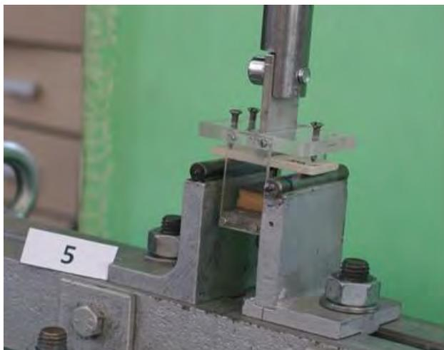
← Měření pevnosti v tahu za ohybu
