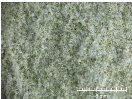
↑ Typické poškození zdrsňelého povrchu s naléhavou potřebou konsolidace
