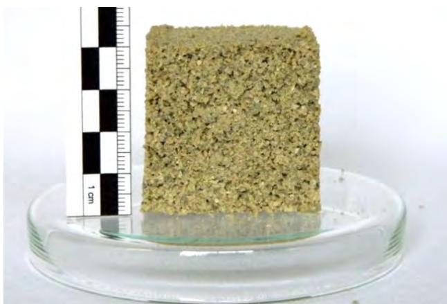
← Zkušební tělísko zhotovené z vápencového písku St. Margarethen po vyjmutí z formy a vysušení
