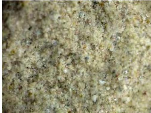
↑ Selektivně erodovaný povrch (mikrofoto). Viditelné zdrsnění a pórovitý povrch vápence i částečné obnažení jednotlivých zrn vápence..
