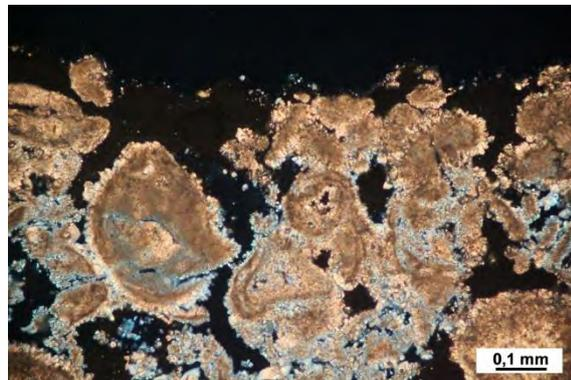
↑ Výbrus vzorku kamene s erodovaným povrchem, optická mikroskopie, procházející světlo, skřížené nikoly. Na obou fotografiích výbrusů je patrné oslabení vzájemného propojení zrn vápence, co pak způsobuje písčovatění povrchu
