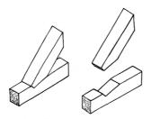
Fig. 2 Oblique step joint [23]
