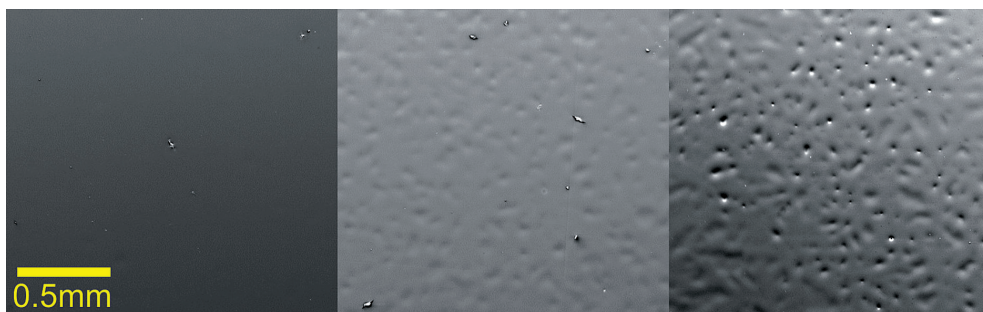
OBRÁZEK 74: Vývoj topografie povrchu s pokračováním umělého stárnutí zaznamenaný SEM sondou sekundárních elektronů
