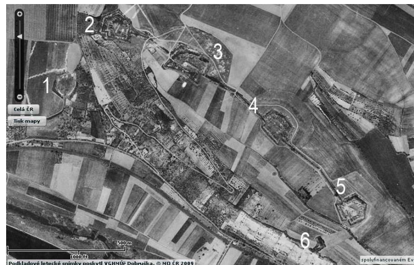
Obr. 6 Letecký měřický snímek zachycující celkový stav opevnění v polovině padesátých let 20. století (1954). V této době byly ještě všechny forty včetně spojovací linie zachovány v terénním reliéfu; interní část (plocha uvnitř valů, nikoliv obvodový příkop) některých z nich (zřetelně objekt 2 a 5) byla již částečně zavezena. Fotografie mimo jiné dobře dokládá, jak v okolí opevnění stále ještě převládá starší mozaika menších soukromých polí, již teprve později vystřídaly velké plochy polí státních statků a zemědělských družstev Zdroj: VGHMÚř (dostupné na http://kontaminace.cenia.cz – projekt NIKM).
