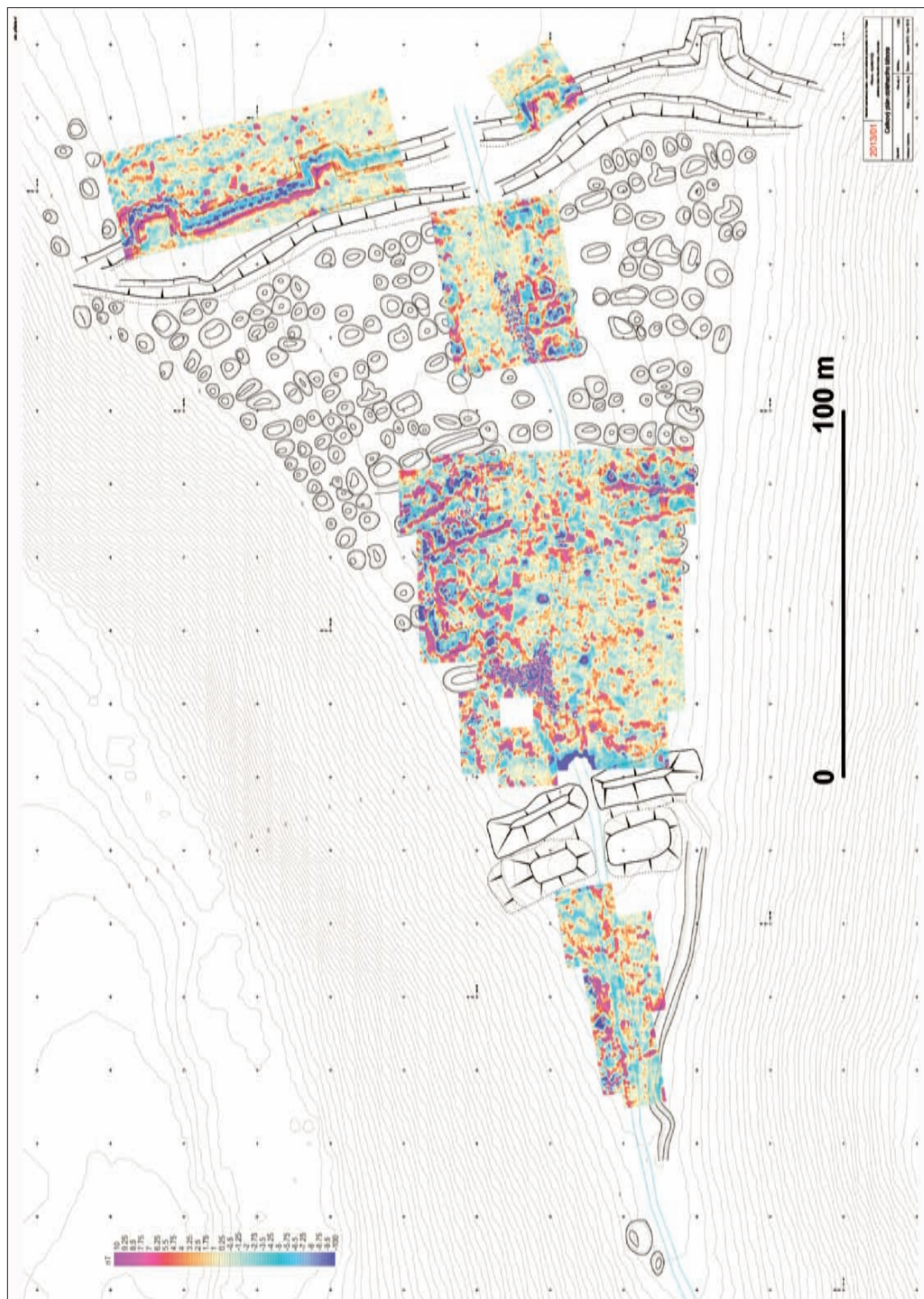
Obr. 12. Kombinace nového plánu tábora a výsledků magnetometrických měření. – Fig. 12. Combination of new camp plan and the results of magnetometric survey.
