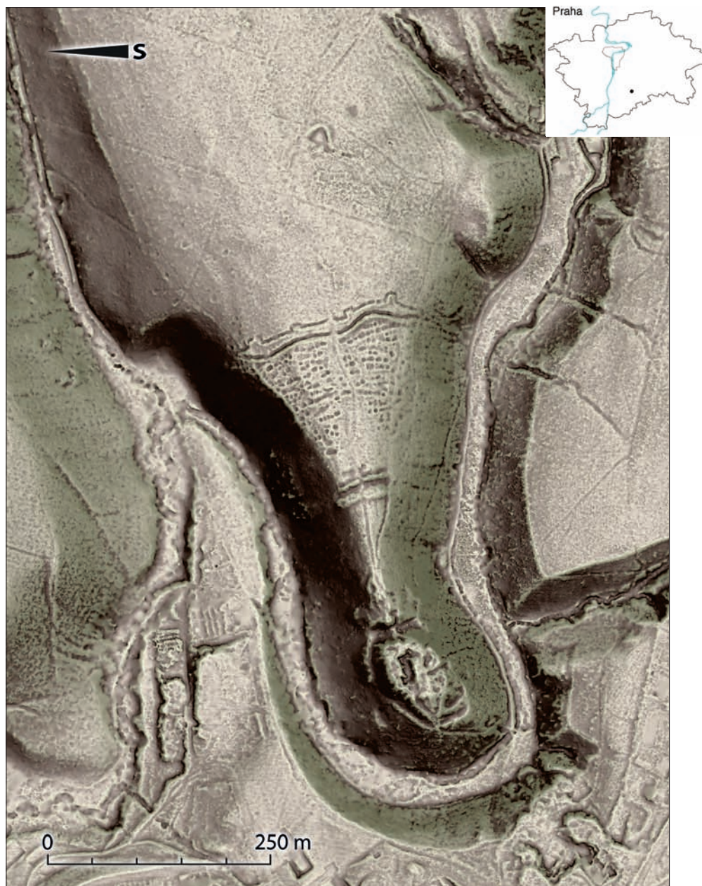
Obr. 1. Okolí Nového hradu u Kunratic, na předpolí jsou dobře patrné reliktů tábora obléhatelů (srov. obr. 3 a 4). Digitální model reliéfu terénu, odvozený z dat LLS. Kombinovaná vizualizace stínování (hillshade), svažitosti a barevné hypsometrie. Data LLS po robustní filtraci poskytl ČÚZK Praha, interpolace Kriging a Natural Neighbour, rastr buňky 0,5 metru. Zpracoval O. Malina 2014.
