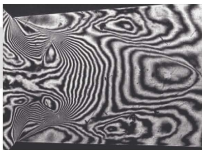
Interferogram proudění vzduchu v modelu parního ventilu.
