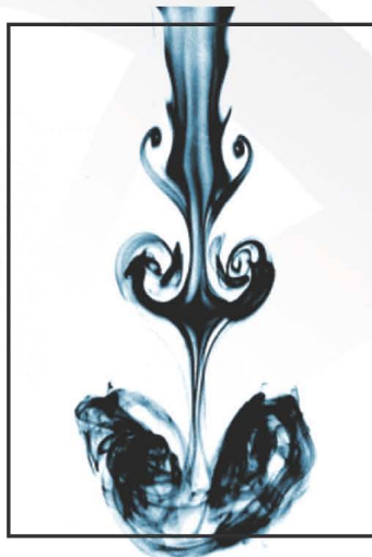
Vizualizace zatopeného proudu vzduchu zachycuje koherentní vírové struktury na jeho okrajích a jejich rozpad.
