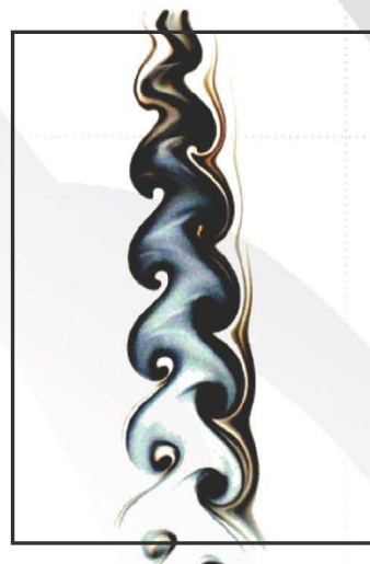
Vizualizace proudění v úplavu za chlazeným válcem (Kármánova vírová řada).
