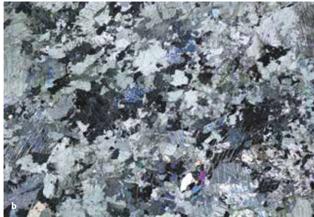
22 Příklady strukturní variability ze souboru vzorků: vzorek ZK 3 – hrubozrný heteroblastický krystalický vápenec (a); vzorek ZK 6 – rekrystalizovaný jemnozrný až středně zrnitý heteroblastický slabě dolomitizovaný krystalický vápenec (b). Zobrazená pole mají délku 6,1 mm.
