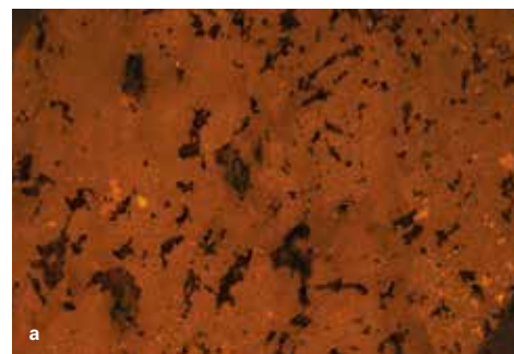
67 Katodová luminiscence: projev dolomitizace – zatlačování kalcitu dolomitem u vzorku HL 1 (a), zobrazené pole má délku 5,6 mm; modře luminiscenční ortoklas, sericitizace zrn ortoklasu se projevuje světlými šmouhami u vzorku NO 1 (b), zobrazené pole má délku 1,4 mm; pásek silikátů tvořený zrny plagioklasu (zelený), ortoklasu (modrý), flogopitu a diopsidu (oba bez luminiscence – tmavě hnědé), vzorek HL 2 (c), zobrazené pole má délku 2,8 mm.
