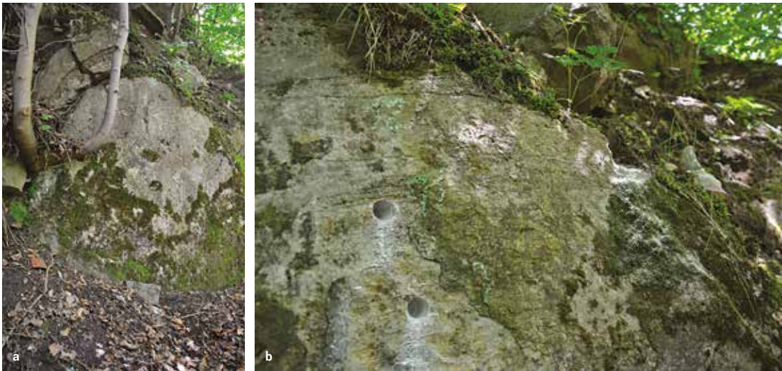
40 Foto lomové stěny (a) a pozice vzorků SS 4-10 a 4-11 (b). Vzorky byly číslovány zdola a odebrány jádrovým vrtákem o průměru 26 mm.
