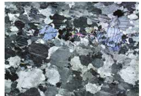
70 Výbrus hrubozrnného krystalického vápence od Sedlišť u Jimramova SD 1. OM, zkřížené nikoly. Zobrazené pole má délku 5,9 mm.
