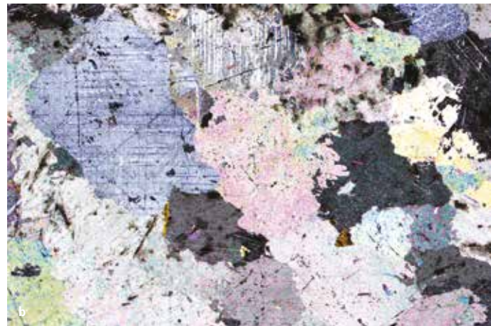
41 Příklady strukturní variability krystalických vápenců z profilu lomu U Štoly u Studnic: jemnozrnný až střednězrnný heteroblastický krystalický mramor s přímými hranicemi zrn, vzorek SS 4-2 (a); hrubozrnný heteroblastický krystalický vápenc se suturovitými hranicemi zrn, vzorek SS 4-6 (b). Zobrazená pole mají délku 6,2 mm.
