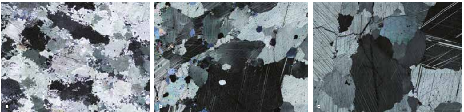
65 Výbrusové vzorky krystalických vápenců z lokality Hradní lom: HL 1 (a), HL 2 (b), HL 3 (c). OM, zkřížené nikoly. Zobrazená pole mají délku 5,5 mm.
