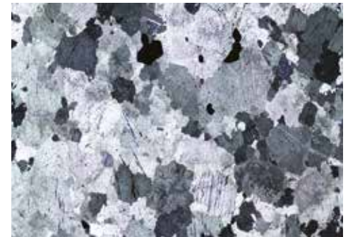
69 Struktura hrubozrnných krystalických vápenců z Trhonic u Jimramova ve výbrusu VJ 1. Zobrazené pole má délku 5,9 mm.
