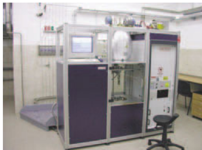
2/ Aparatura Aixtron na depozici diamantových vrstev
