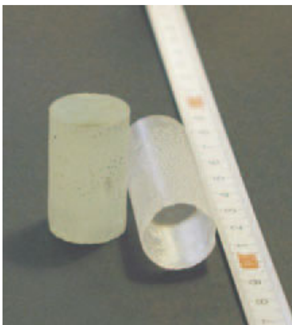
1/ Krystaly CsPbCl 3 (vlevo) a PbCl 2 (vpravo) připravené růstem z taveniny Bridgmanovou metodou
