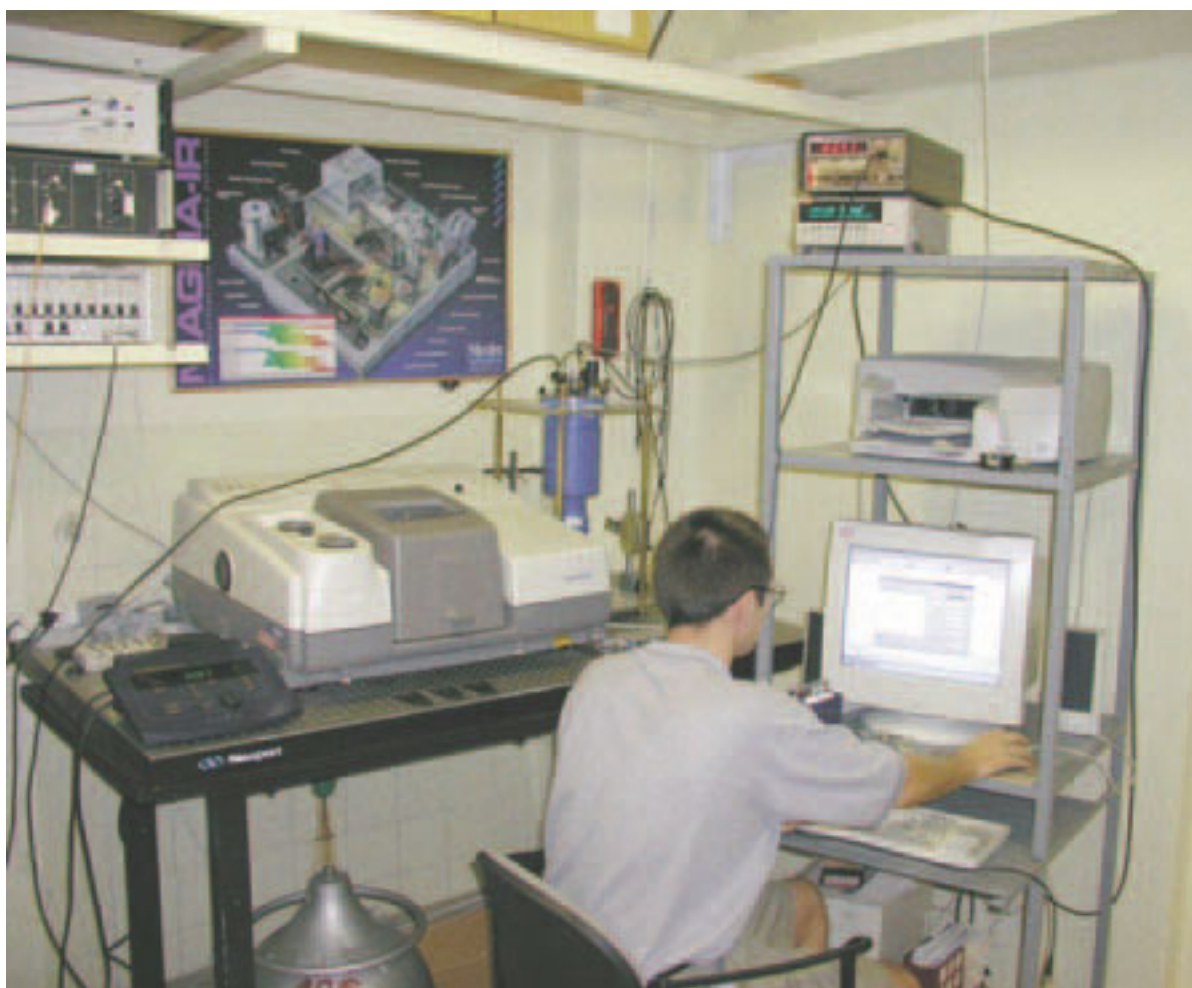
3/ Měřicí aparatura FTPS ( Fourier Transform Photocurrent Spectroscopy )
