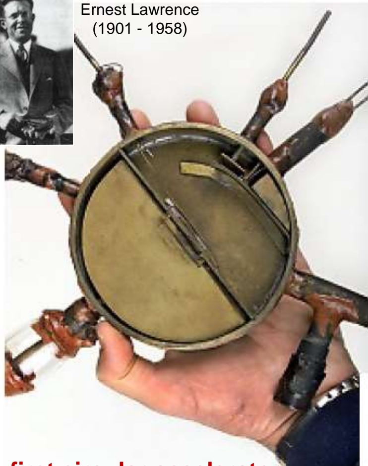
The first circular accelerator (Berkeley 1930)
