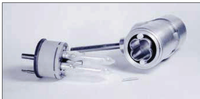
Obr. 4 Rubínový laser v rozloženém stavu: mezi výbojky se uchytuje rubínový krystal (tyčinka v popředí), čtyřeliptická dutina se použila k dosažení vyšší účinnosti čerpacího záření (květen 1963)
