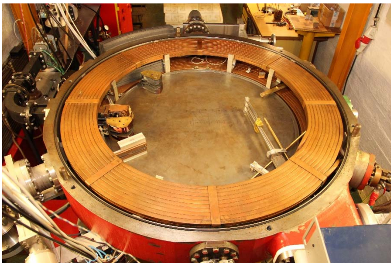
Pohled na urychlovací komoru mikrotronu MT25.
