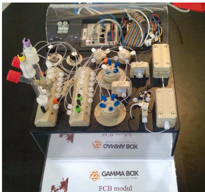
Automatizovaný modul pro konverzi ^{18}\text{F} na elektrofilní formu.
