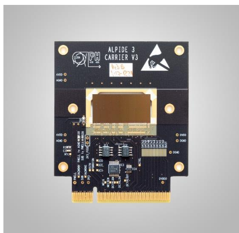
Testovací sestava pro ozařování na cyklotronu U-120M (vlevo), detailní pohled na zkoumaný křemíkový čip ALPIDE (vpravo).
