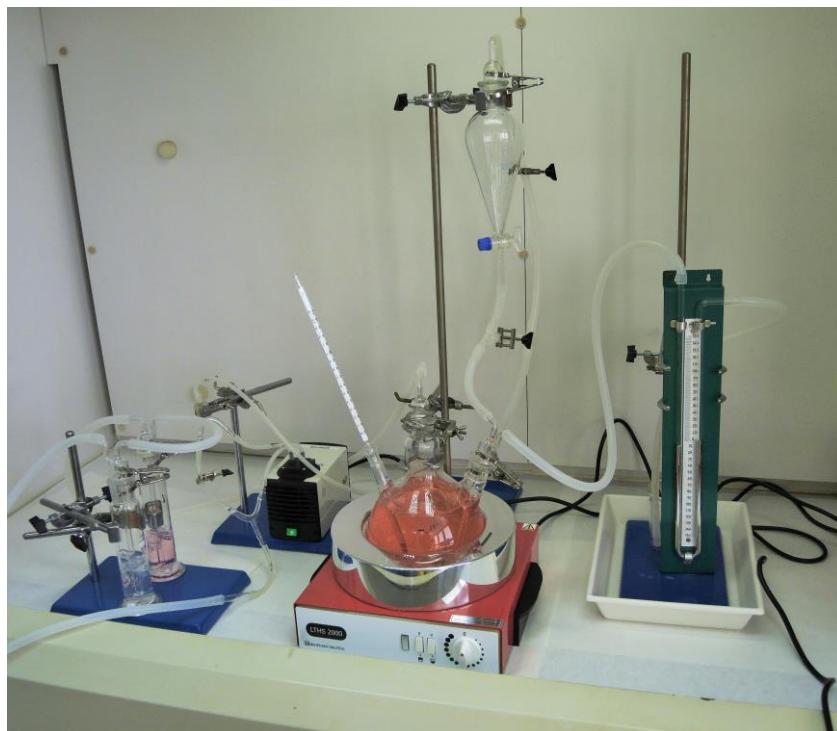
Aparatura pro cirkulační zpracování chemických forem ^{14}\text{C} ze vzorku vody před měřením kapalnou spektrometrií (laboratoř LRKO ETE).
