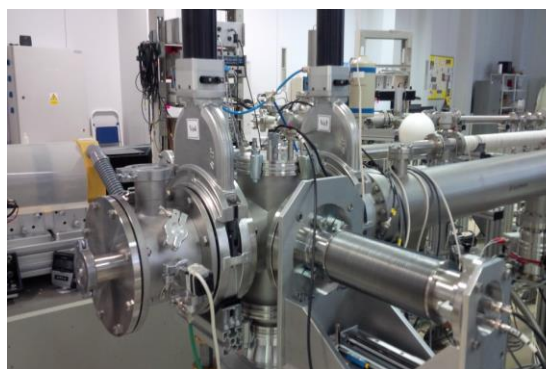
Obr. 4. Nová multifunkční implantační komora pro modifikaci materiálů iontovými svazky.
