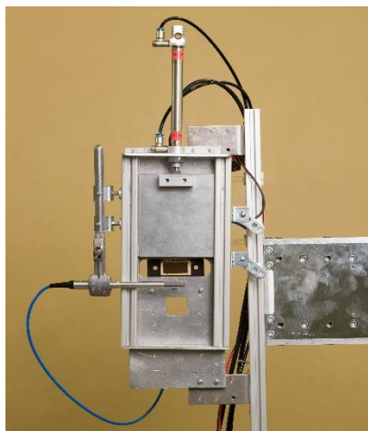
Testovací sestava pro ozařování na cyklotronu U-120M (vlevo), detailní pohled na zkoumaný křemíkový čip ALPIDE (vpravo).
