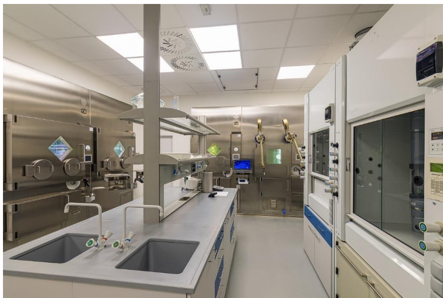
Radiochemická laboratoř nad cyklotronem TR-24 – pohled na celek čtyř polohorkých komor a dvou radiochemických digestoří ke zpracování ozářených terčů a výzkumu značených sloučenin.
