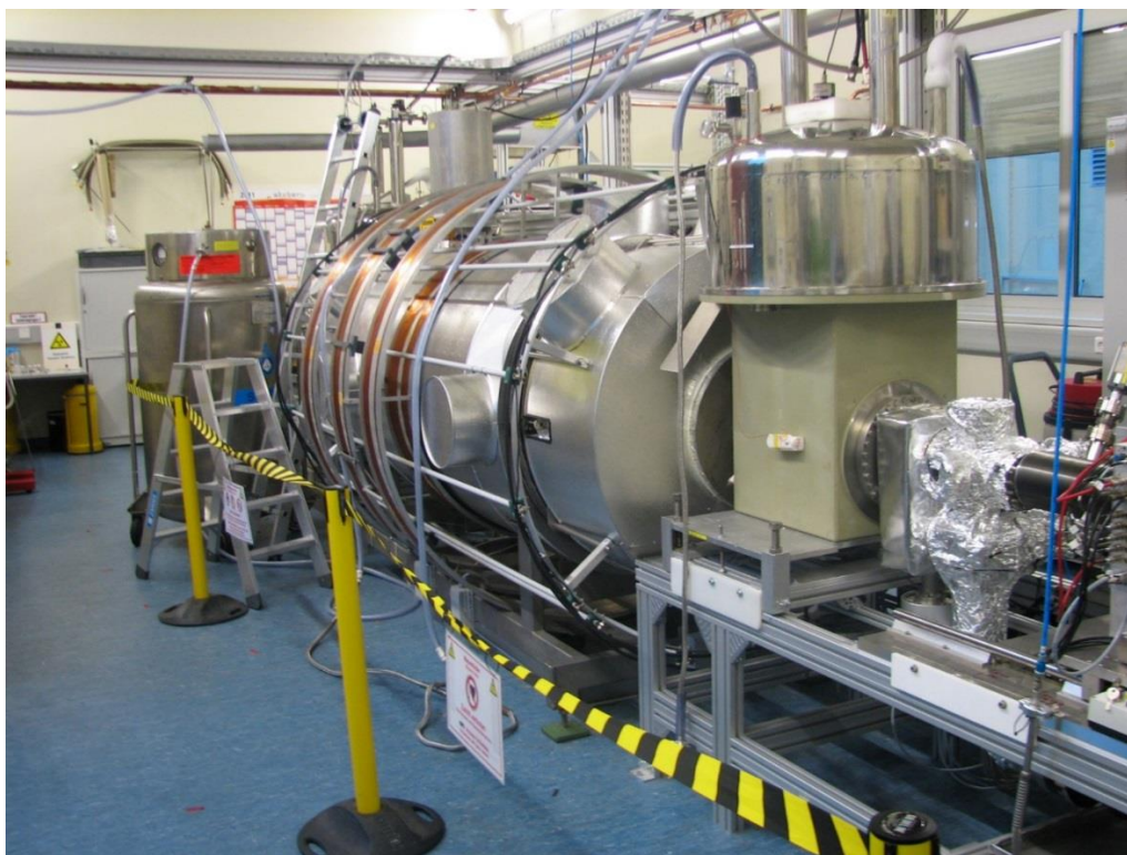
Monitorovací spektrometr mezinárodního neutrinového experimentu KATRIN. Naši pracovníci jsou zapojeni zejména do činností spojených s monitorováním a kalibrací.
