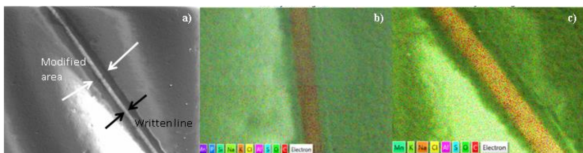
Obr. 2. Mikrostruktura vytvořená protony s energií 1,2 MeV při iontových tocích řádově 10^{14} iontů/cm 2 . (a) Vizualizace mikrostruktury v GO optickým mikroskopem, (b) a (c) EDX prvková analýza mikrostruktury zobrazující úbytek O a nárůst C uvnitř mikrostruktury.
