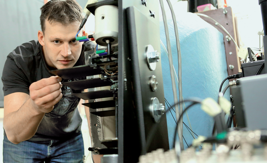
KMITÁNÍ. Pavel Procházka sestavuje aeroelastický model lopatek. Cílem experimentu je zjistit jejich kmitání vyvolané proudem vzduchu.
