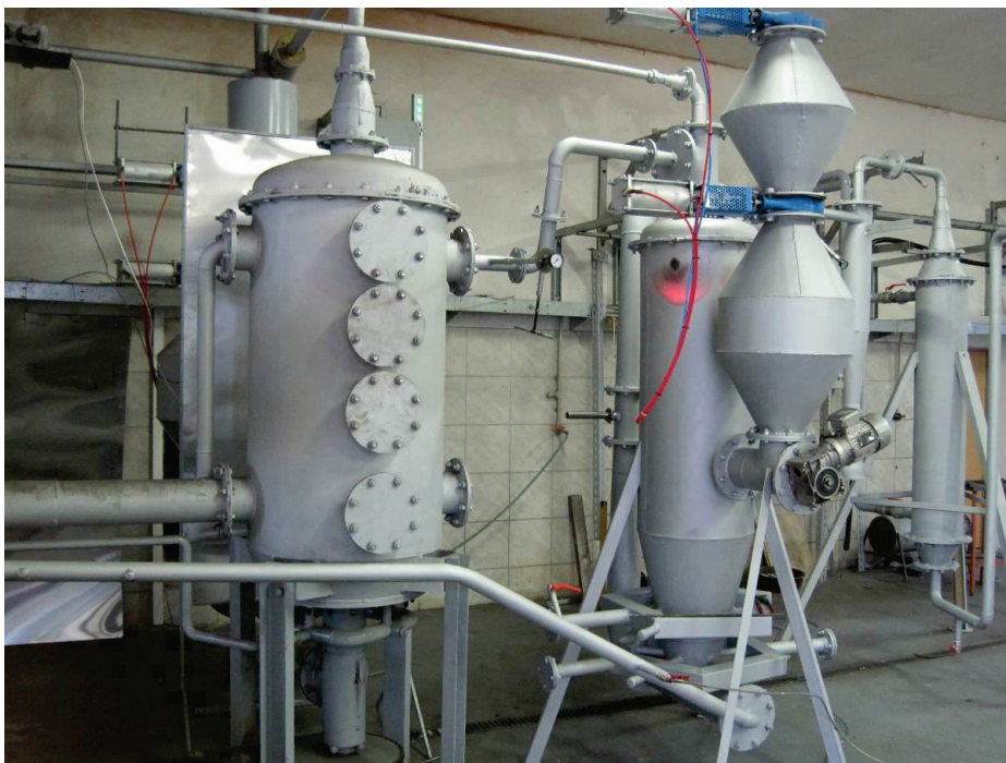
Dvoustupňové uspořádání zplyňovacího reaktoru v testovacím režimu
