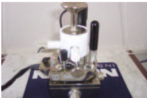
2/ Měřící hlava AFM. V bílých teflonových válcích v horní části přístroje jsou umístěny piezokrystaly zajišťující X-Y posun sondy. Vzorek je umístěn na držáku na posuvném stolku.
