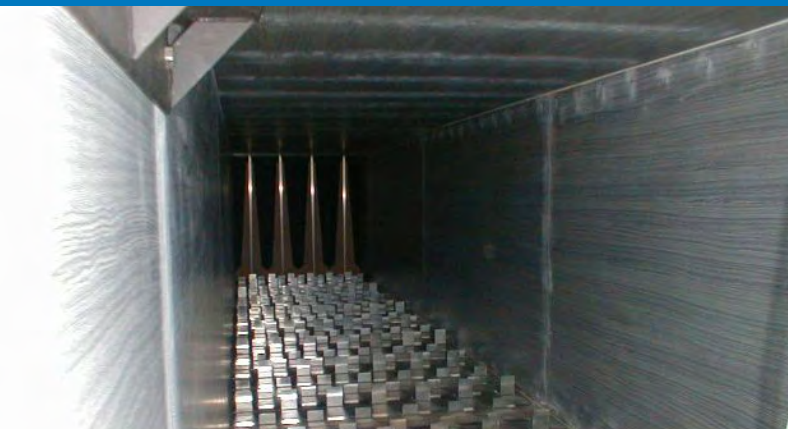
Aerodynamický tunel pro modelování úniku nebezpečných (toxických) látek, projekt Ústavu termomechaniky AV ČR, v. v. i., řešitel: prof. RNDr. Zbyněk Jaňour, DrSc.
