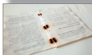
Skada från hot spot inne i bok och brännmärken vid metallklamrar.
