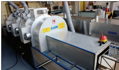
Den patenterade tjeckiska mikrovågstorken.
