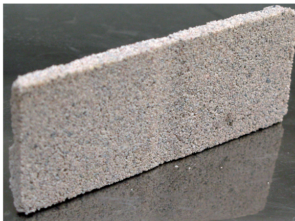
OBRÁZEK 151: Tenká deska pro tahovou zkoušku
