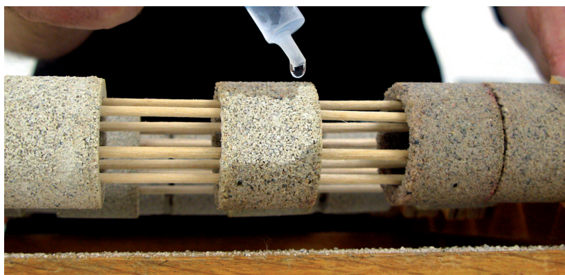
OBRÁZEK 154: Penetrování tenkostěnných rour pro tlakové zkoušky
