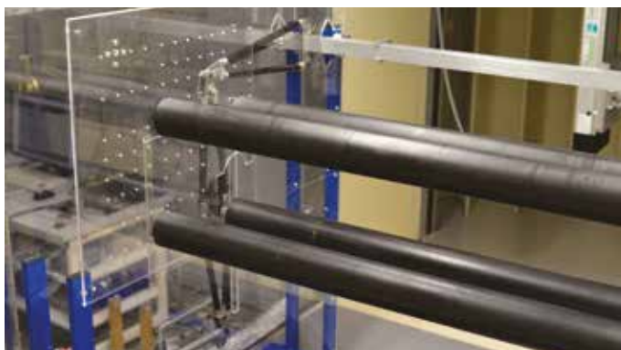
Aeroelastický model čtveřice závěsů umístěný v aerodynamickém větrném tunelu.
