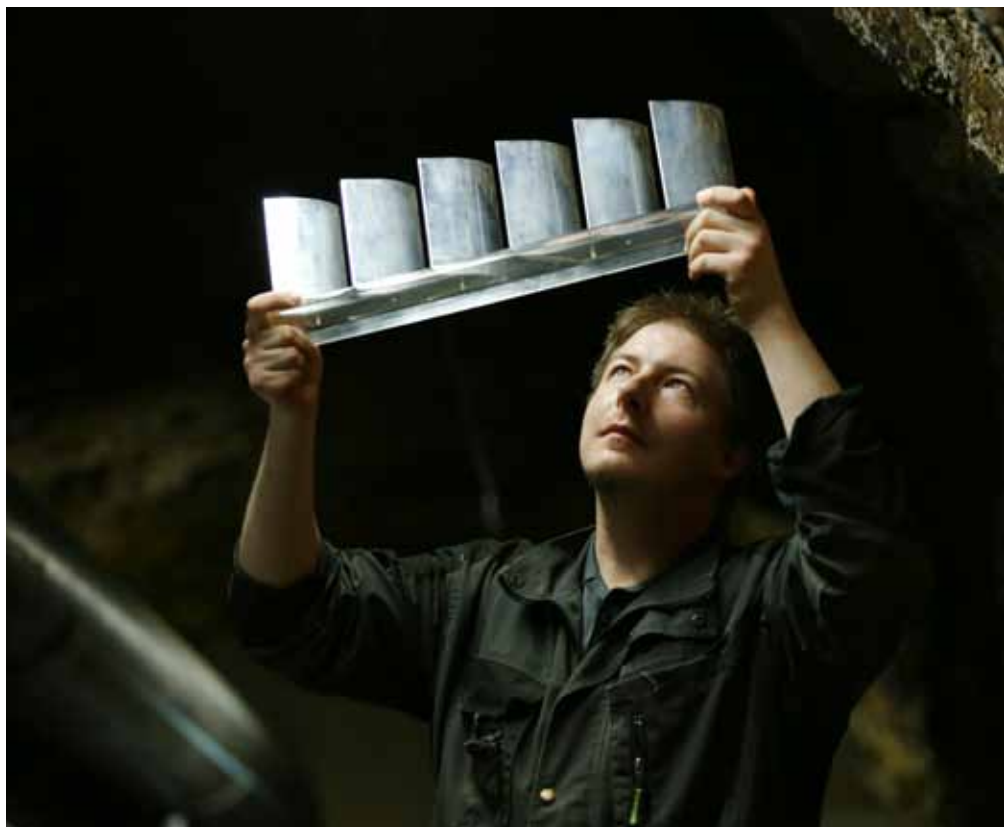
Technik Antonín Zajíček kontroluje model lopatkové mříže před montáží do aerodynamického tunelu.
