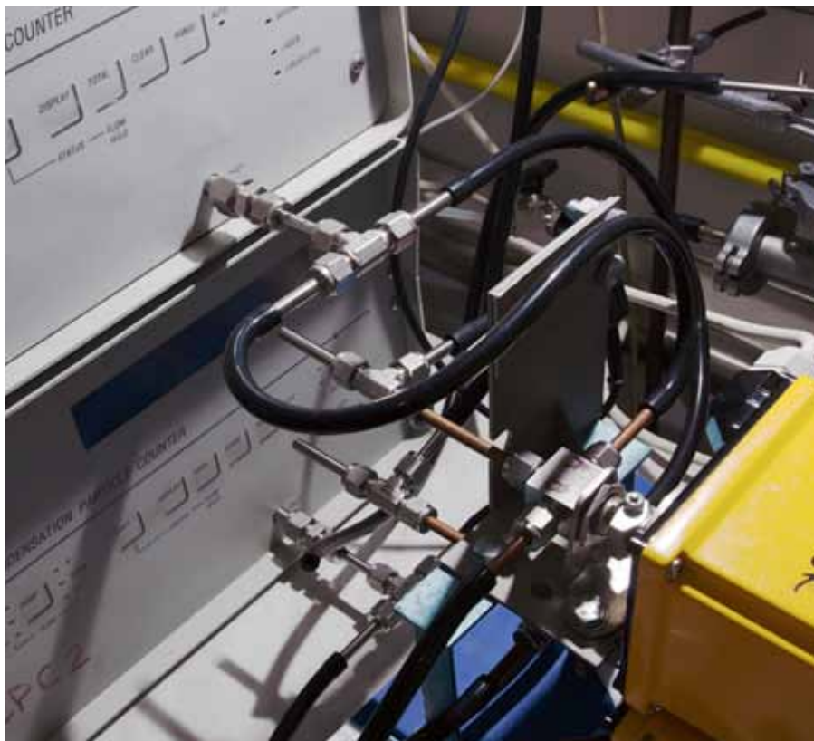
Čítače aerosolových částic – mozek aparatury k měření účinnosti filtrů
