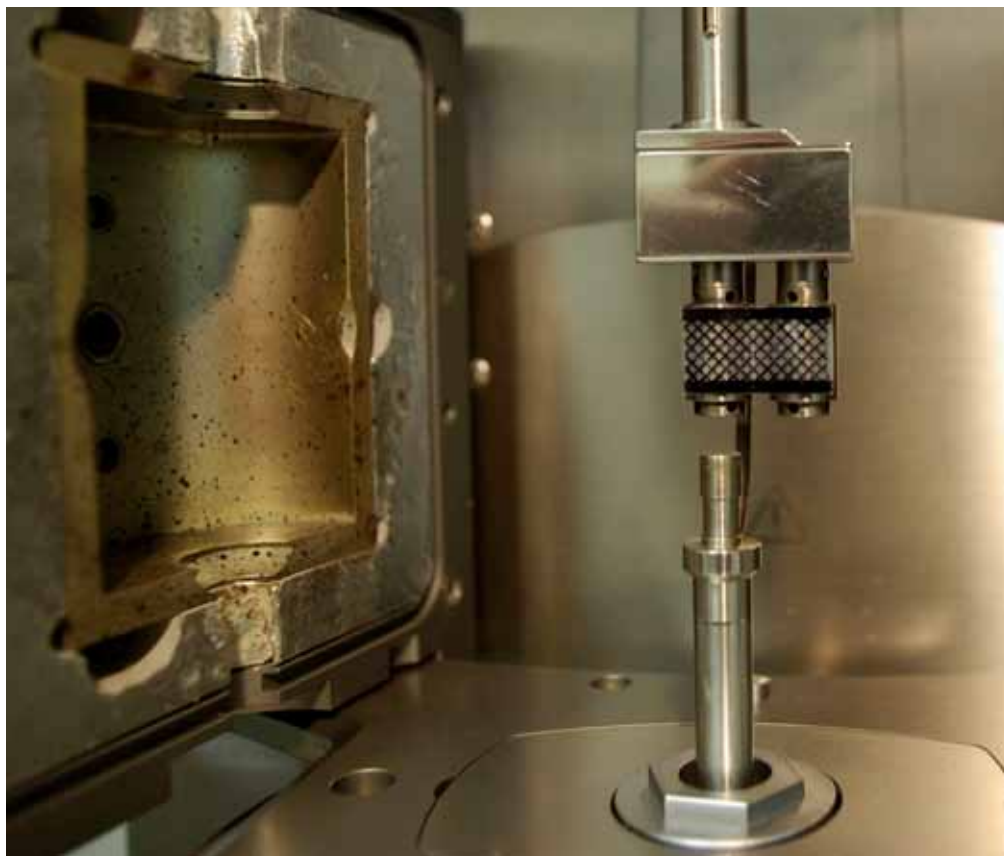
Sentmanatov elongační reometr zabudovaný v rotačním reometru Anton Paar včetně ilustrativního polymerního vzorku
