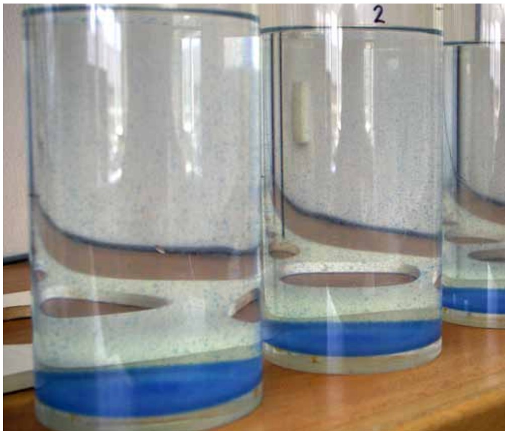
Sklenicová zkouška – optimalizace koagulace
