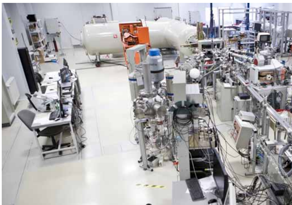
Laboratoř Tandetronu – pohled na iontové trasy s koncovými terčovými komorami pro iontové analytické metody
