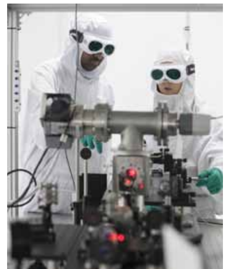
Mikročipová laserová sestava pro testování laserových materiálů a vývoj malých laserových řešení
