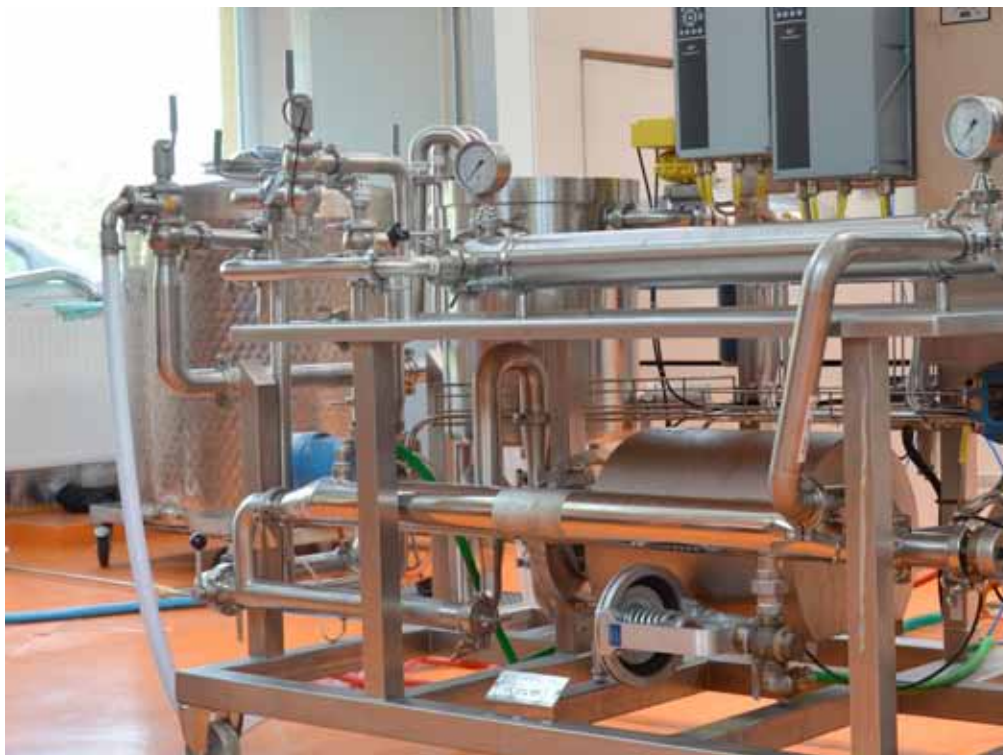
Cross-flow filtrace: univerzální jednotka Alfa Laval M39/M3.8 pro mikrofiltraci, ultrafiltraci, nanofiltraci a reverzní osmózu
