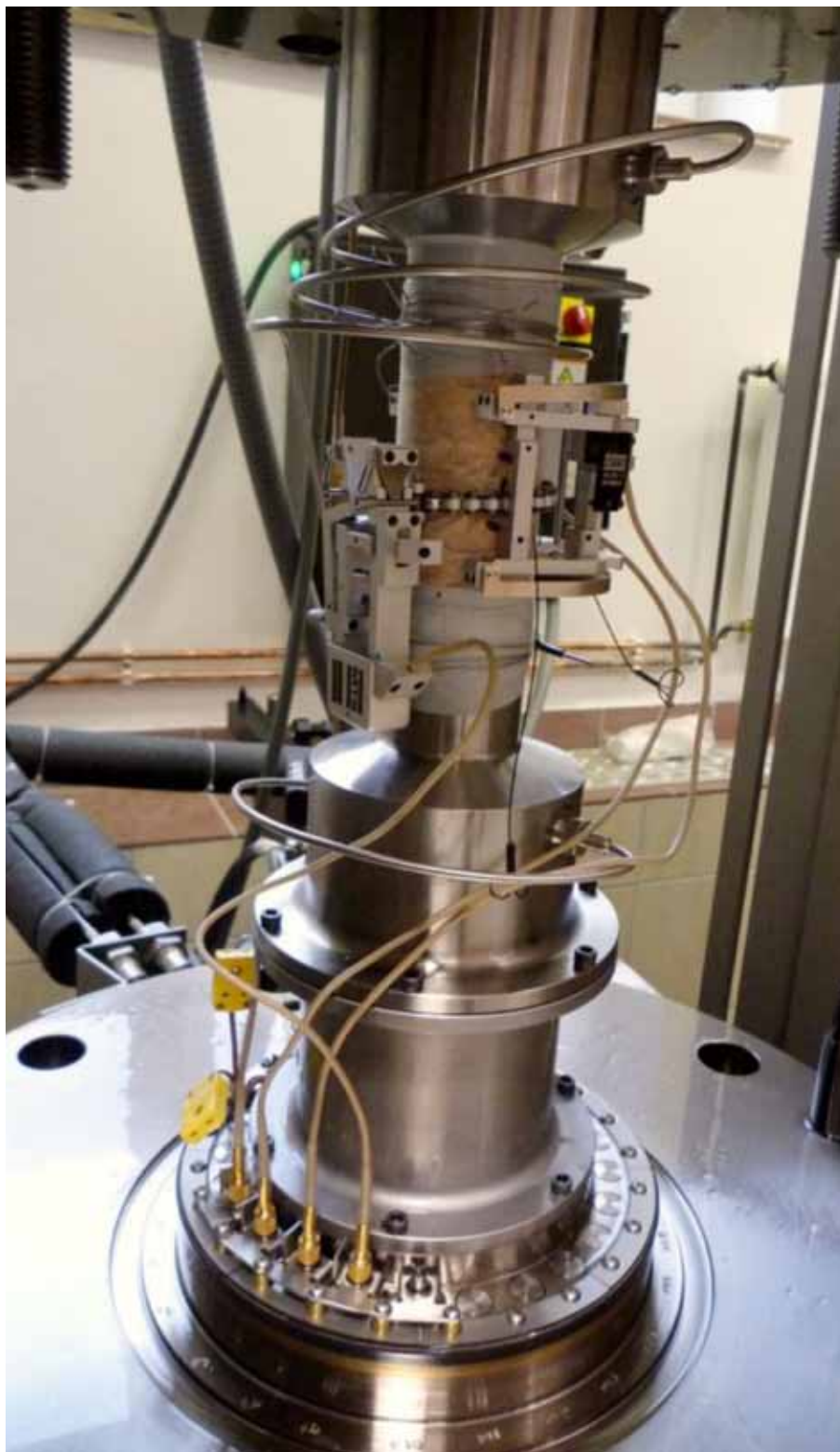
Instalace horninového vzorku pro trojosou zkoušku s aplikací pórového tlaku
