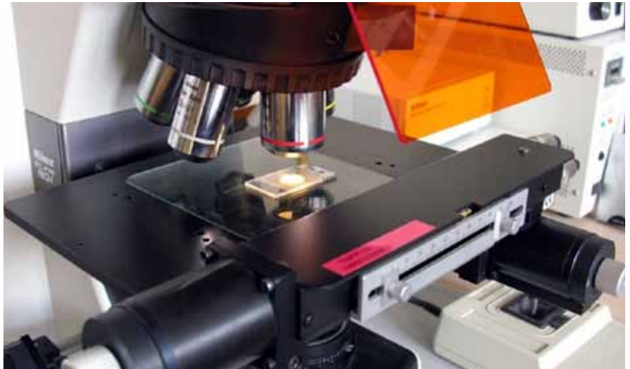
Mikroskopický preparát (horninový výbrus) v procházejícím světle optického mikroskopu NIKON Eclipse 80i
