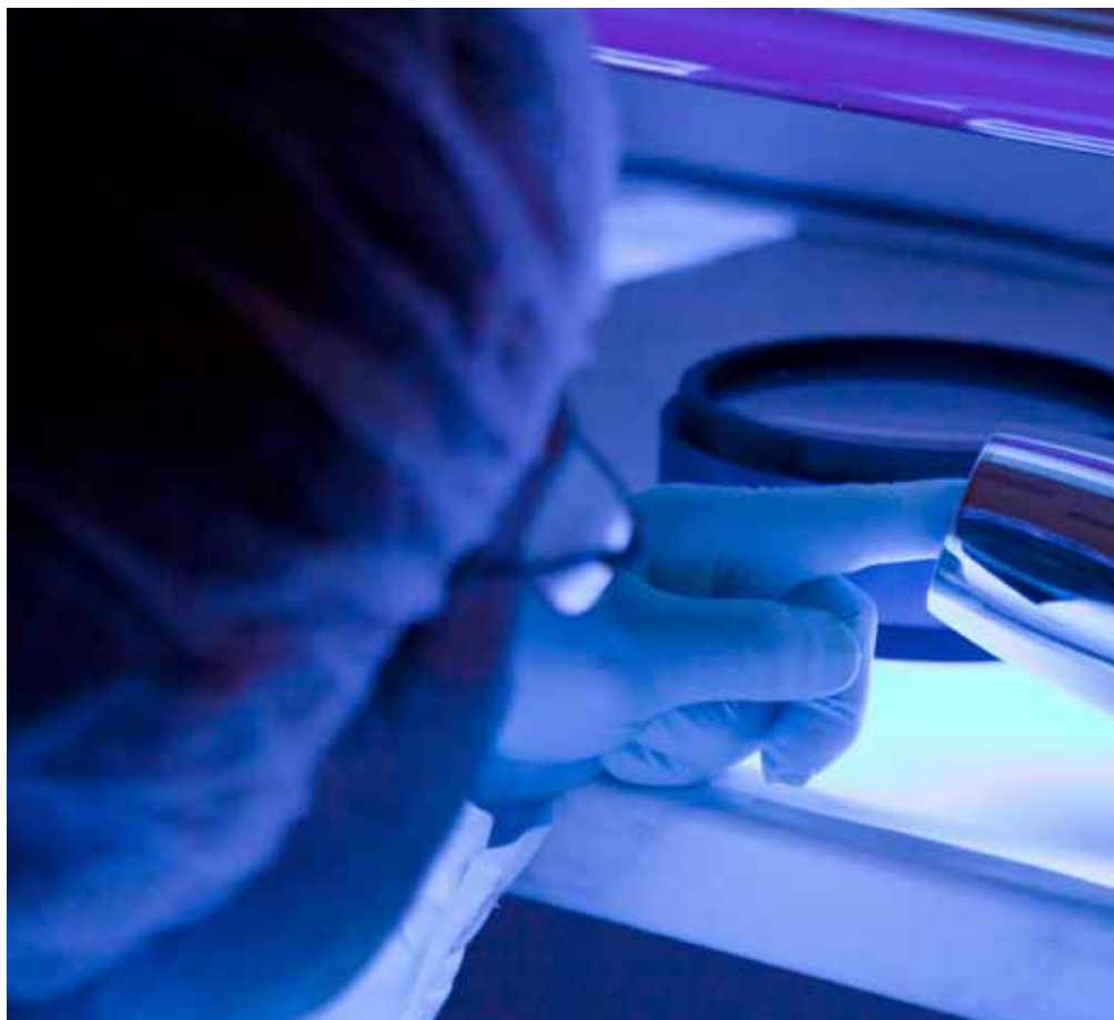
Výstupní vizuální kontrola mandrelu RTG objektivu
