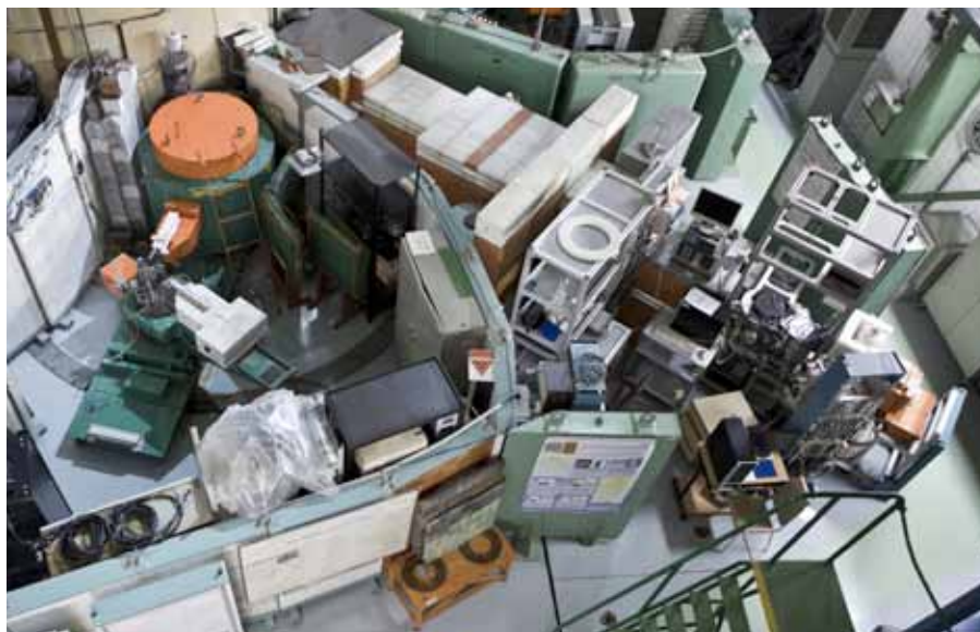
Neutronový difraktometr SPN-100 pro skenování napětí v materiálech a analytické metody pro neutronové hloubkové profilování (vlevo) a promptní gama aktivační analýza (vpravo) na neutronových svazcích u výzkumného reaktoru
