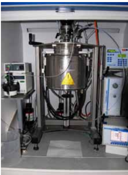
Reaktor sloužící k syntéze nanomateriálů v kapalné fázi, testování katalyzátorů a pro kinetická měření
