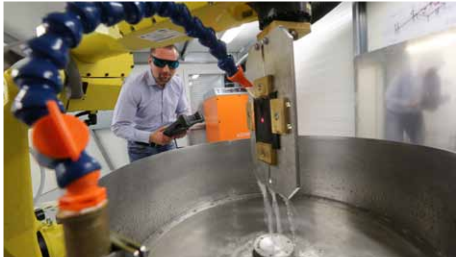
Stanice pro zpevňování a prodlužování životnosti cyklicky namáhaných materiálů pomocí laserem indukované šokové vlny
