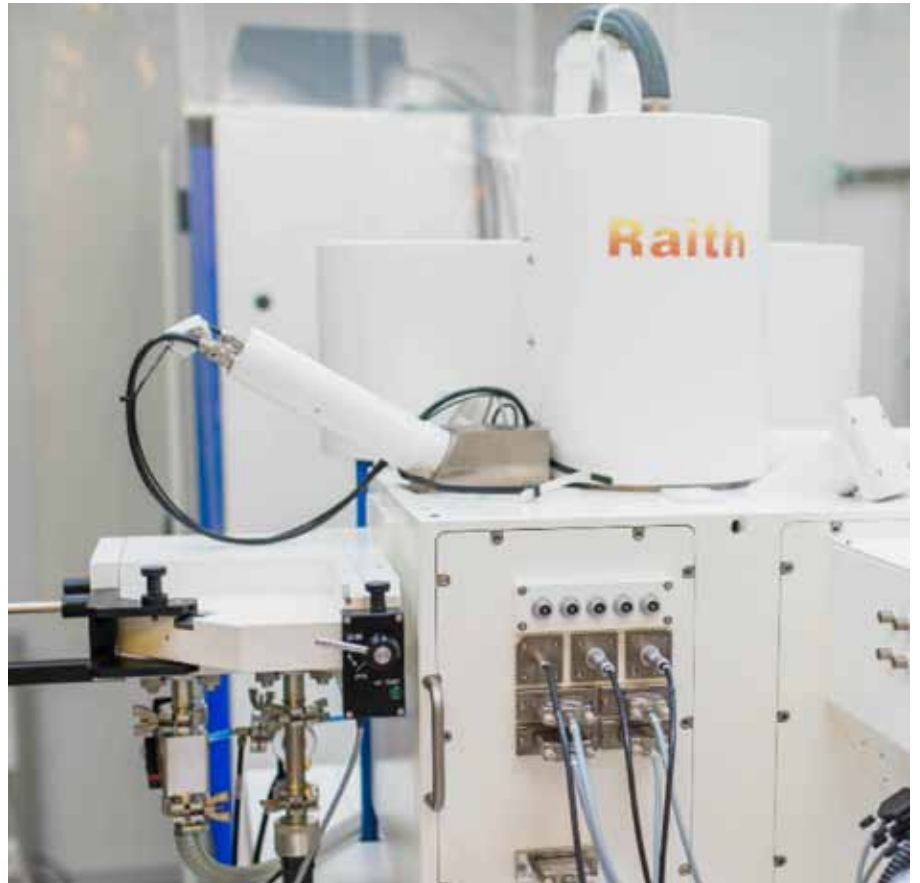
Kombinovaný elektronový litograf
