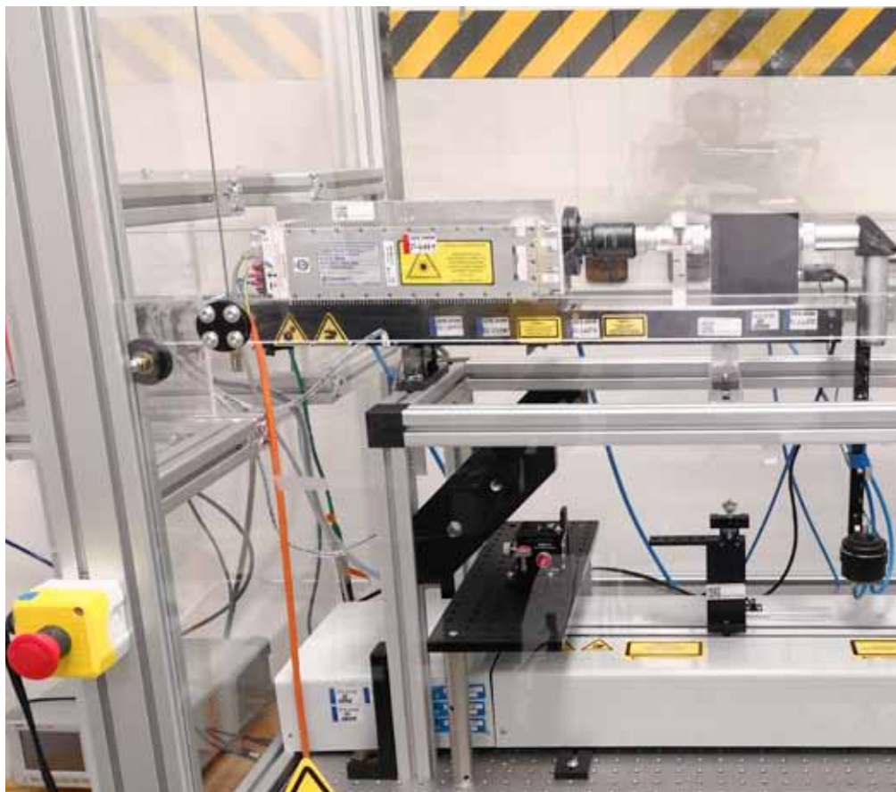
Aparatura s CO 2 laserem pro přípravu speciálních vláknových součástek
