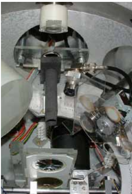
Multifunkční analytická vakuová komora umožňující současné měření rentgenové fluorescence a zpětně odražených iontů
