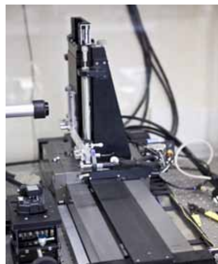
Aparatura s CO 2 laserem pro přípravu speciálních vláknových součástek a vláknových mřížek s dlouhou periodou
