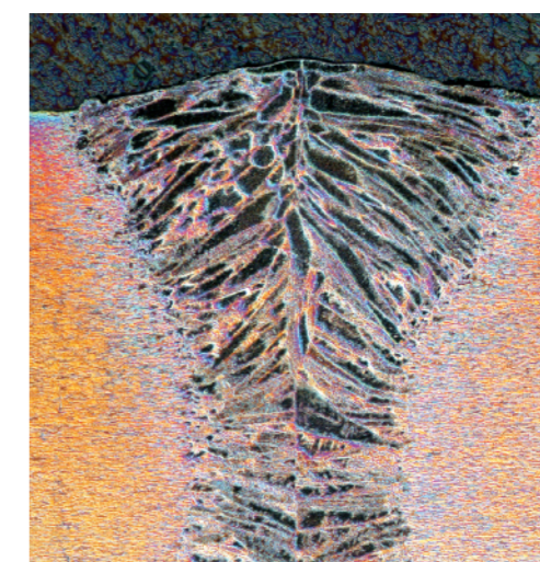
Detail výbrusu svaru laserem zobrazený pomocí Nomarského metody.
