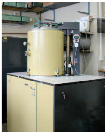
Modernizovaná vakuová pec PZ 810.
