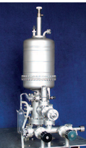
Héliová kryovývěva pro superčisté čerpání vakuových prostorů bez vibrací a bez elektrického napájení.
