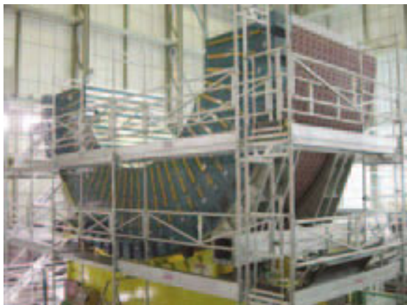
15/ Testovací sestavení hadronového kalorimetru TILECAL v pozemní hale v CERN
