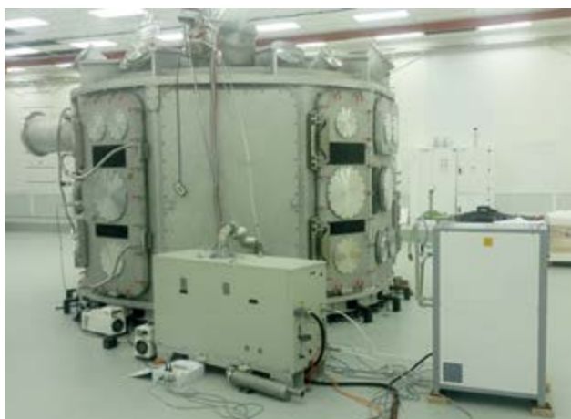
■ Obr. 16 Platforma fyziky plazmatu (P3) instalovaná v experimentální hale E3.
