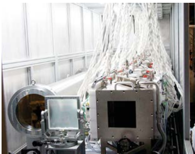
■ Obr. 10 Blok výkonového zesilovače PA1 laserového systému L4 s optickou aperturou 18x18 cm. Tento zesilovač umožňuje zesílit spektrálně širokopásmové pulsy na energii minimálně 100 J.
