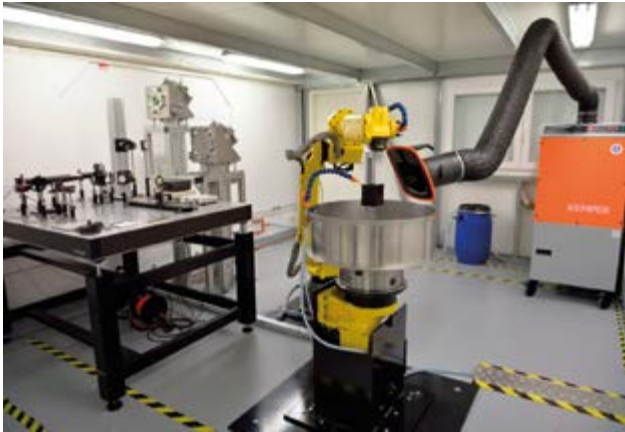
■ Obr. 12 Experimentální stanice LSP pro studium laserového vyklepávání.
