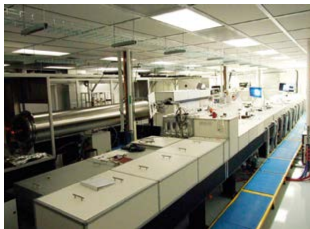
■ Obr. 11 Laserový systém L4 ve vývojové laboratoři National Energetics. V popředí v levé části obrázku jsou oscilátorová jednotka, předzesilovače a systém pro zvýšení časového kontrastu laserových pulsů.
