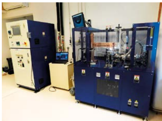
■ Obr. 19 Aparatura pro růst krystalů halogenidů metodou micro-pulling-down.
