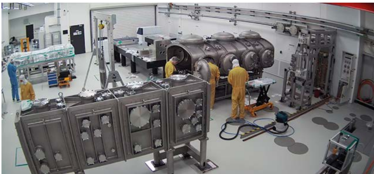
■ Obr. 2 Laserová hala L1 centra ELI-Beamlines v průběhu instalace laserového systému L1-ALLEGRA v závěru roku 2017. Snímek zachycuje okamžik před finální instalací vakuové komory bloku výkonových OPCPA zesilovačů krátkého pulsu.
