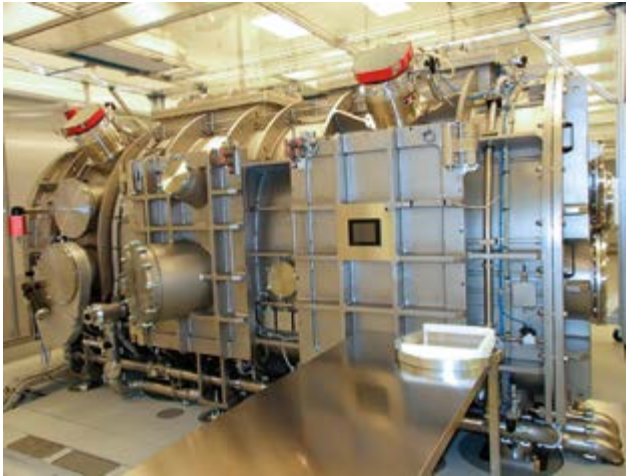
■ Obr. 8 Vakuový optický kompresor (5,2 x 2,2 x 2,3 m) PW pulsů systému L3-HAPLS, navržený v oddělení 91 a realizovaný ve spolupráci s tuzemským průmyslem. Uvnitř vakuové komory jsou integrovány 4 velkoplošné difrakční mřížky (výrobce LLNL) pro kompresi laserových pulsů na finální délku <30 fs a soustava optických zrcadel včetně diagnostických zrcadel pro měření parametrů výstupního pulsu. Kompresor dále zahrnuje řadu elektronických a optoelektronických senzorů a komplexní elektronický řídicí systém.
