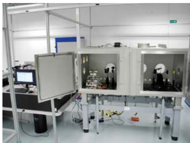
Obr. 11 Experimentální stanice LIDT pro měření prahu poškození.
