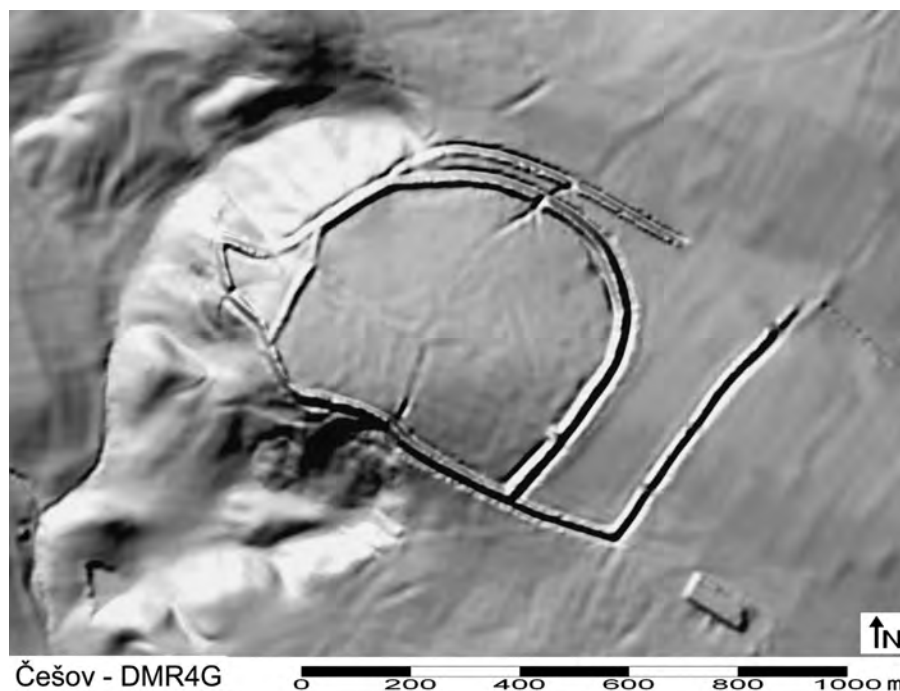
Obr. 2. Hradiště Češov (okr. Jičín). Digitální model terénu vytvořený na základě dat zakoupených od Českého úřadu zeměměřického a katastrálního (digitální model reliéfu 4. generace – DMR 4G). Prostorové rozlišení 5 m.
