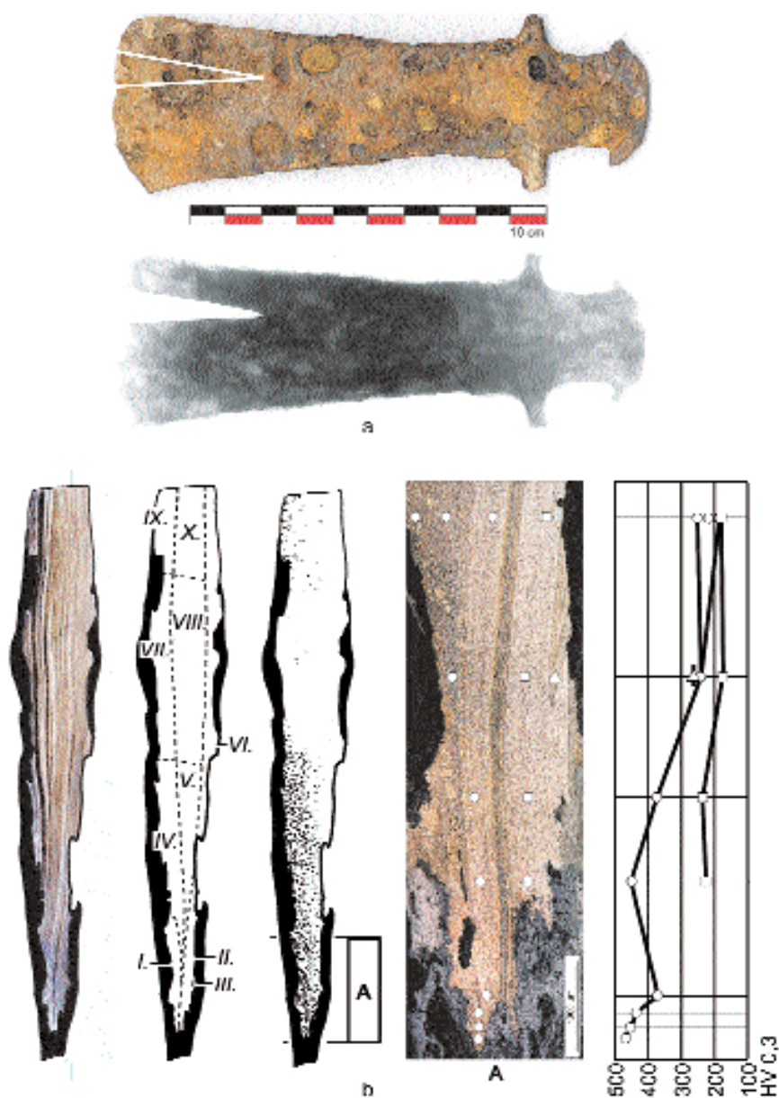
Obr. 6. Sekerka s raménky č. př. 205/05; vrch Ostrý, k. ú. Březno; a – sekerka ve stavu před restaurováním s vyznačením odebrání vzorku a rtg snímek; b – nákresy a fotografie zkoumaného vzorku a graf průběhu tvrdosti (zleva: po naleptání Oberhofferovým roztokem, rozložení popisovaných oblastí, rozložení struktur po naleptání nítalem). Foto J. Hošek.
