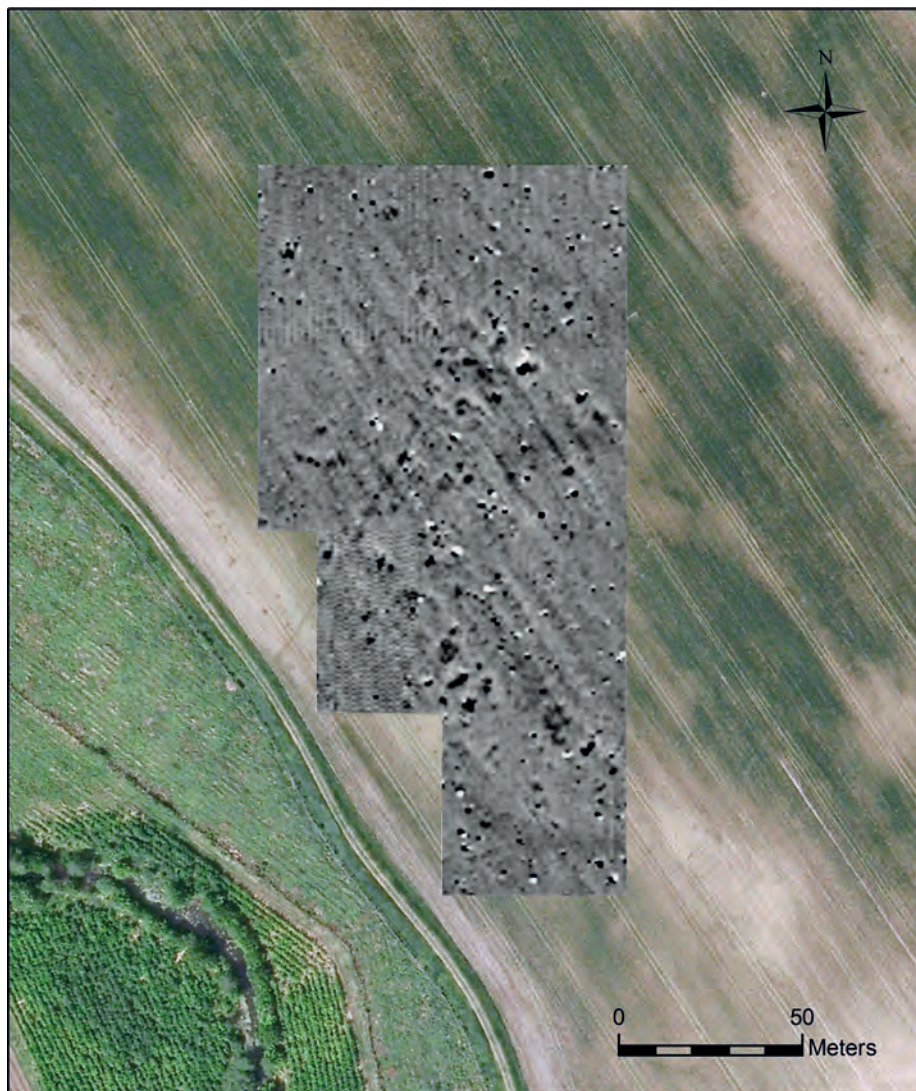
Obr. 14. Kostice – Zadní hrúd 2. Magnetogram, céziový magnetometer SM-5 Navmag Scintrex, dynamika nameraných hodnôt -2/+2 nT v 256 stupňoch šedej škály (biela/čierna), raster 0,10 m/1,00 m.
