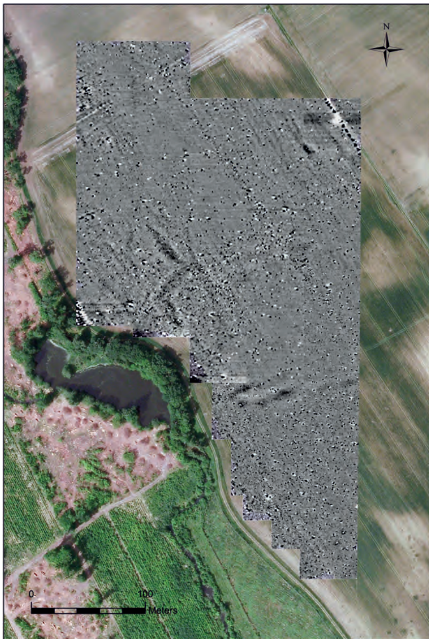
Obr. 5. Kostice – Zadní hrúd 1. Magnetogram, céziový magnetometer SM-5 Navmag Scintrex, raster 0,10 m/1,00 m a fluxgate-gradiometer Förster Ferex 4.032 DLG, raster 0,25 m/0,50 m, dynamika nameraných hodnôt -2/+2 nT v 256 stupňoch šedej škály (biela/čierna).
