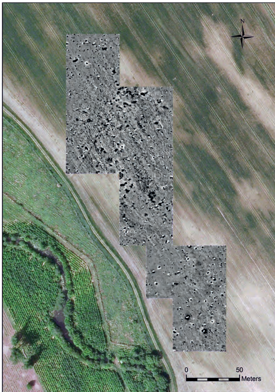
Obr. 15. Kostice – Zadní hrúd 2. Magnetogram, fluxgate magnetometer Förster Ferex 4.032 DLG, dynamika nameraných hodnôt -2/+2 nT v 256 stupňoch šedej škály (biela/čierna), raster 0,25 m/0,50 m.
