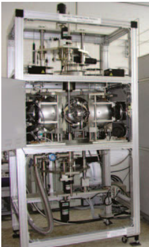
3/ Nově instalované zařízení pro růst krystalů visutou zonální tavbou se světelným ohřevem do 3000 °C je sedmé na světě.
