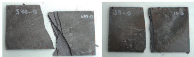
Obr. 4: Ukázka lomové plochy vzorků břidlice po zkoušce pevnosti v tahu za ohybu – vzorek ze severní strany s patrnou delaminací (obrázek vlevo), krytina z jižní strany střechy (obrázek vpravo)
