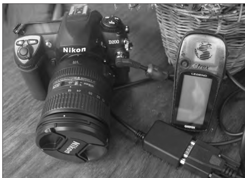
Obr. 2. Nejmodernější způsob pořizování fotografií v oblasti leteckého průzkumu nabízí spojení digitálního fotoaparátu a navigačního přístroje (stanice GPS) prostřednictvím speciálního propojovacího kabelu.
