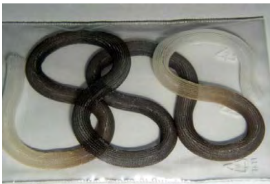
■ Příklad textilní cévní náhrady pokryté „diamantem“ metodou laserové depozice.
