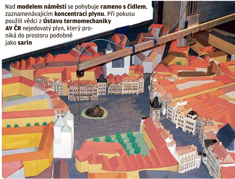
Model Staroměstského náměstí, obsahující detailní repliky 45 základních domů a paláců první linie, byl umístěn v padesátimetrovém aerodynamickém tunelu, který umožňuje simulovat vzdušné proudění ve výšce několik desítek až stovek metrů nad zemským povrchem
