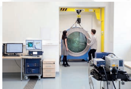
Laboratoř laserové rotační vibrometrie se zkušebním lopatkovým kolem.
