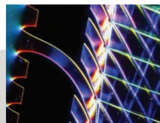
Barevný šlírový obraz proudění v modelu parního řezu oběžného kola posledního stupně parní turbíny velkého výkonu. Rychlost páry za modelem (na obrázku vpravo) je 1,9x vyšší než rychlost zvuku.
