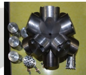
Magnetokumulativní implozivní generátor plazmatu pro přímou přeměnu kinetické energie plazmatu na elektřinu.
