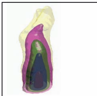
Prostorová rekonstrukce viditelného záření v proudu termálního plazmatu.
