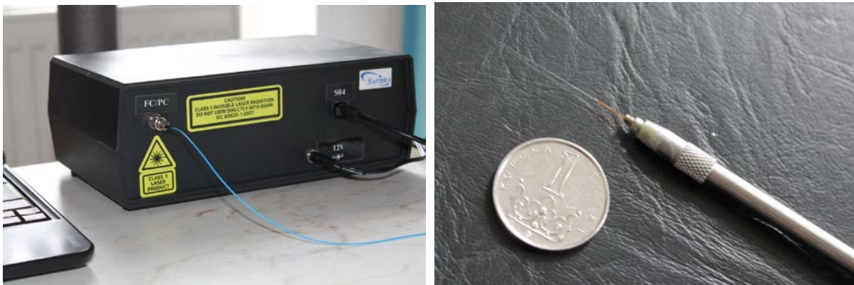
Obr. 4 Fotografie optoelektronické jednotky vláknové-optického pH-metru a optické sondy.
