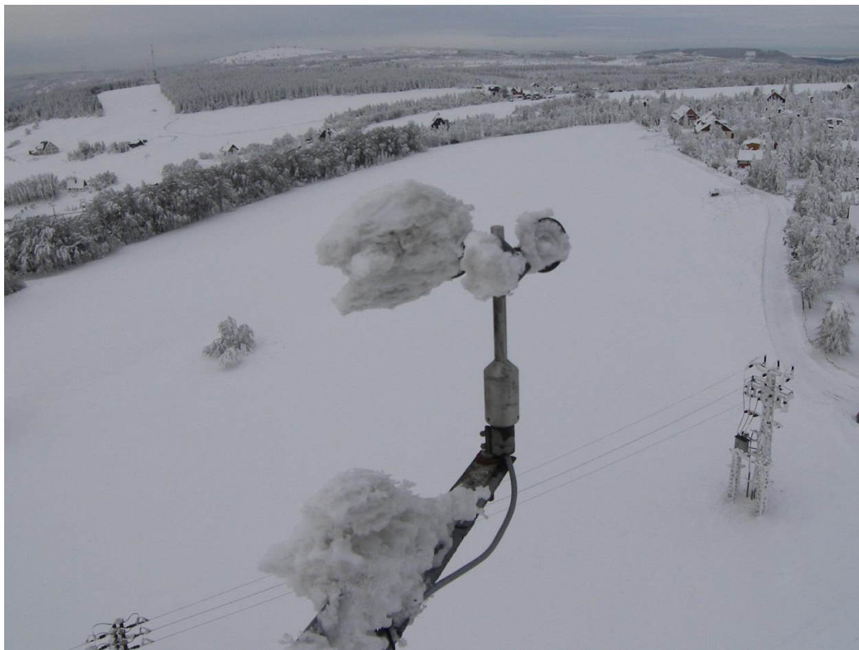
Obr. 2.23 Námraza na (nevyhříváném) miskovém anemometru na stožáru Dlouhá Louka v Krušných horách.
