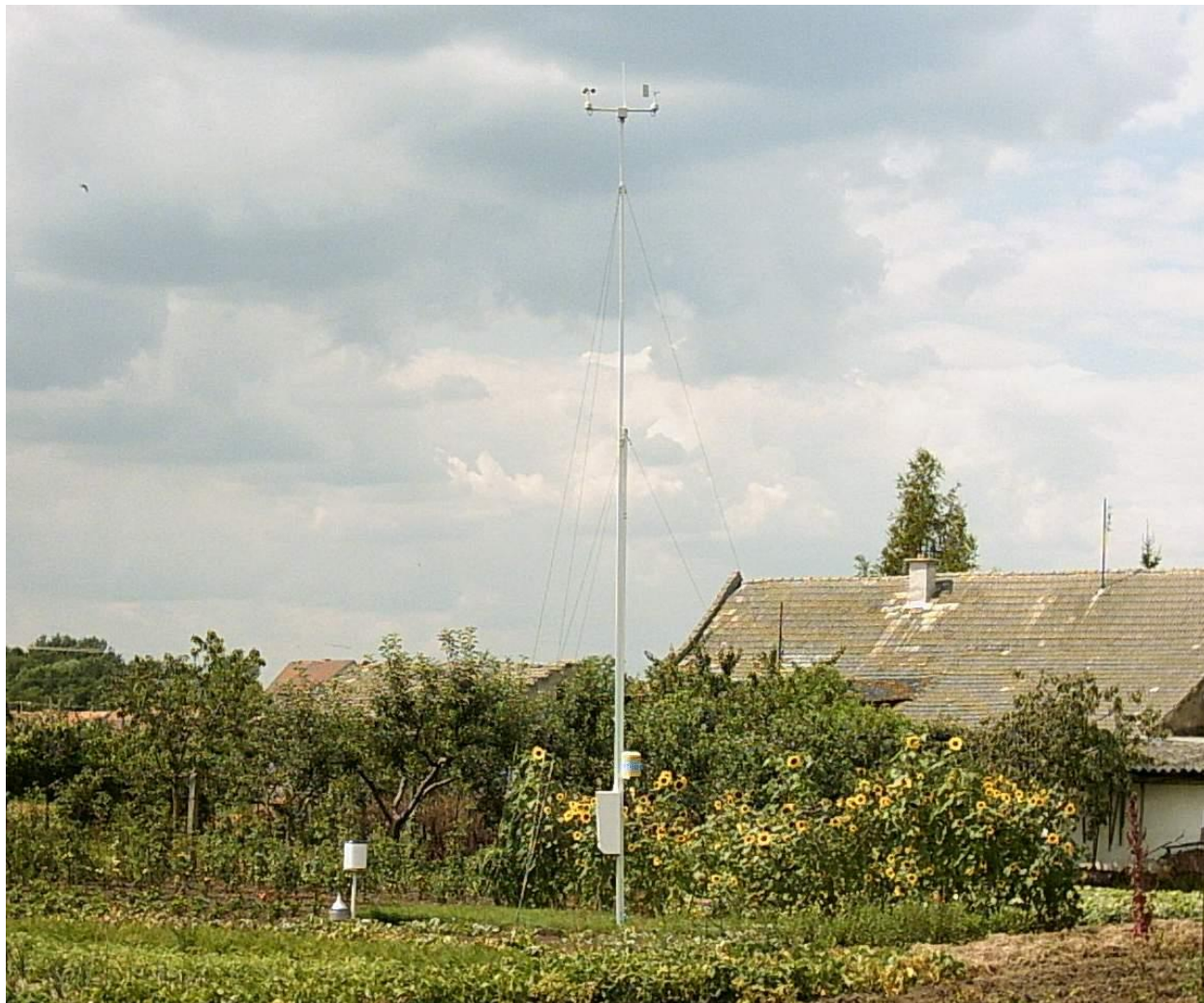
Obr. 4.12 Příklad dobrovolnické automatizované stanice (Brod nad Dyjí, rok 2004). Ve směru fotografie je řada domů s velkým vlivem na proudění, v okolí se nacházejí další komplexní překážky. Tato stanice je tak na hranici využitelnosti pro modelování větru.
