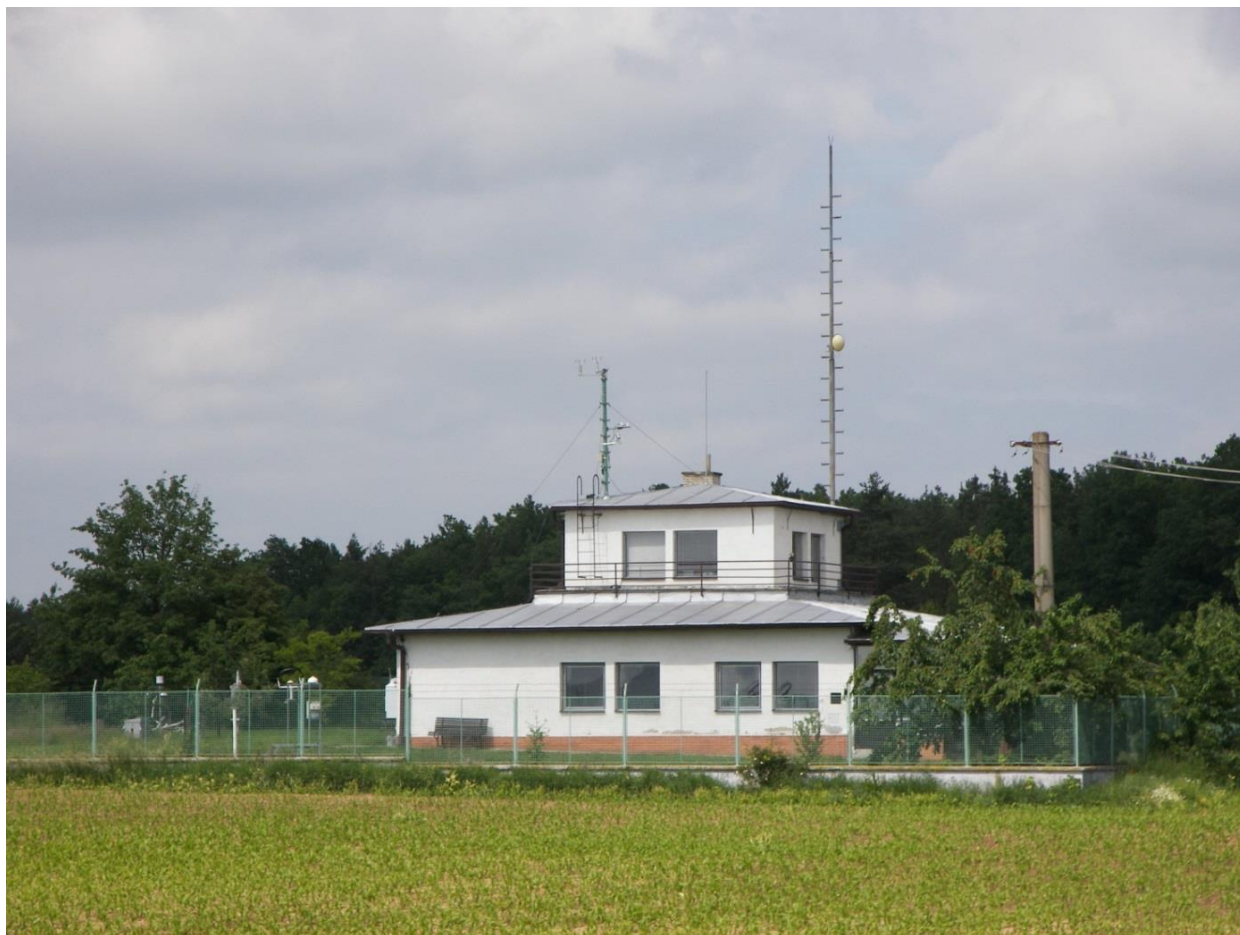
Obr. 2.17 Foto stanice Kuchařovice. Tato stanice byla použita jako předloha "typizované" profesionální meteorologické stanice. Vedle umístění anemometru nad střechou domu lze očekávat ovlivnění naměřených větrných podmínek lesním porostem v pozadí (tento potenciálně značný vliv je zde limitován nízkou četností proudění ve směru od lesa), blízkými stromy, vlastním měřícím stožárem a sousedním anemometrem.
