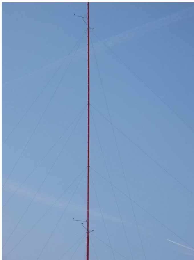
Obr. 2.7 Stožárové měření větru analyzované v Ukázce 1 . Na obrázku jsou senzory ve výškách 31 a 57 m nad zemí.
